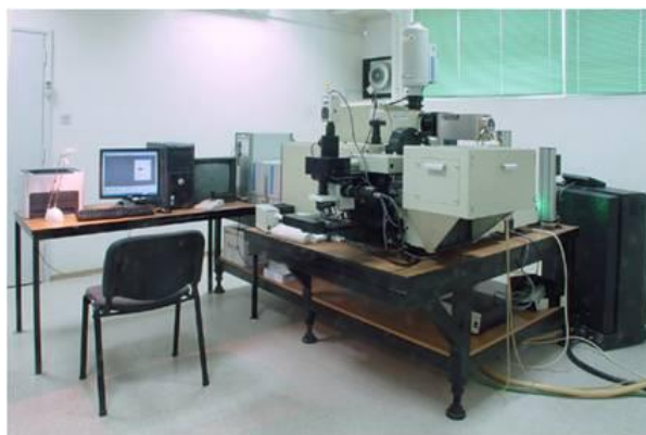
Slika 4.4. Ramanov uređaj u Laboratoriju za molekulska fiziku Instituta Ruđer Bošković
