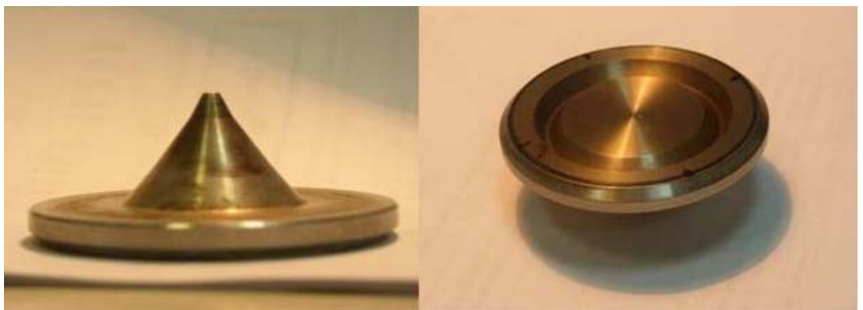
Slika 2.16. Homogenizator snopa X-zraka od 6 MV
