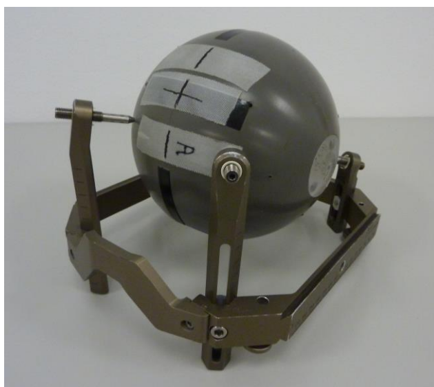
Slika 2.19 Akrlonitrilbutadinstirenski fantom - ABS (Elekta AB, Stockholm, Švedska) učvršćen u Leksellov stereotaktički okvir.
