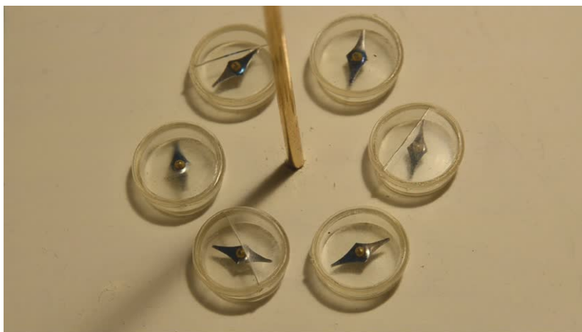
Slika 7.2: Pokus s magnetskim iglama kojima se prikazuje smjer magnetskog polja vodiča kojim teče struja [27].
