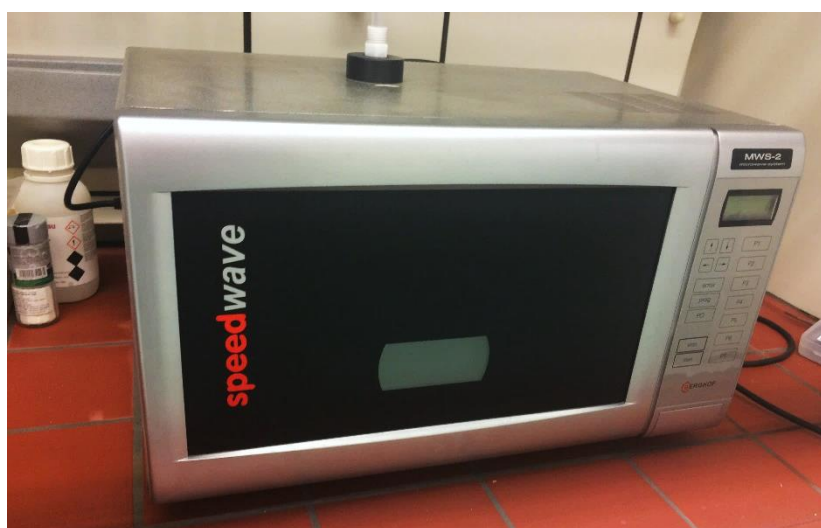
Slika 8. Uređaj za mikrovalno potpomognuto razaranje (MWS-2 Microwave System Speedwave BERGHOF )
