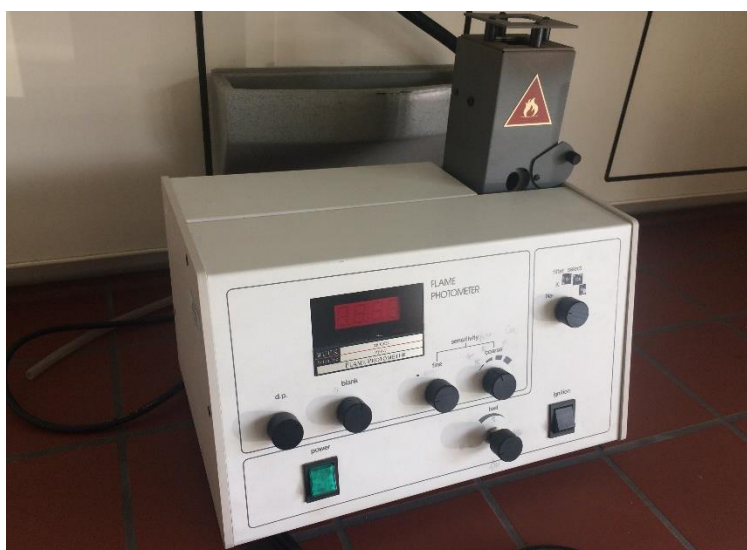
Slika 10. Plameni fotometar Buck / Jenway PFP7
