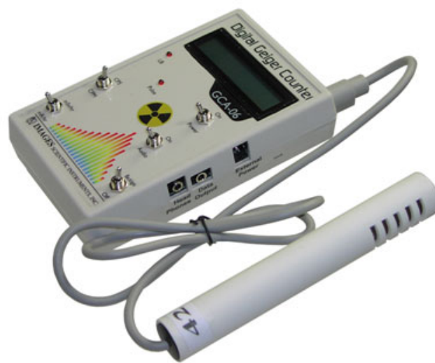
Slika 5.2: Geiger Müllerov brojač.
