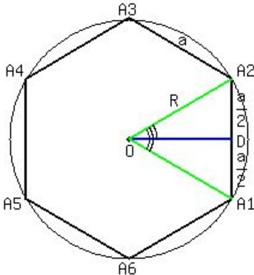
Slika 3.2: Aproksimacija PET konstrukcije u z-smjeru na primjeru 6 modula [19]
