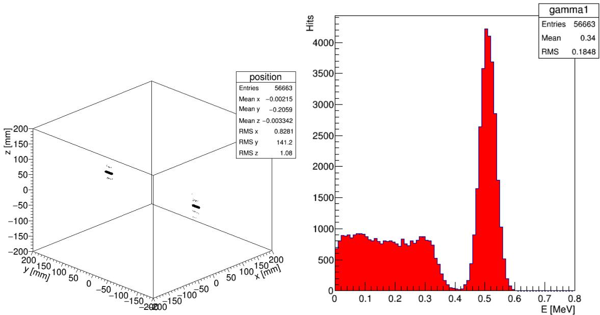
Slika 3.13: Prostorni raspored koincidentnih parova u PET konstrukciji (lijevo) i raspoljeda deponirane energije  $\gamma$  fotona (desno) za model 2+
