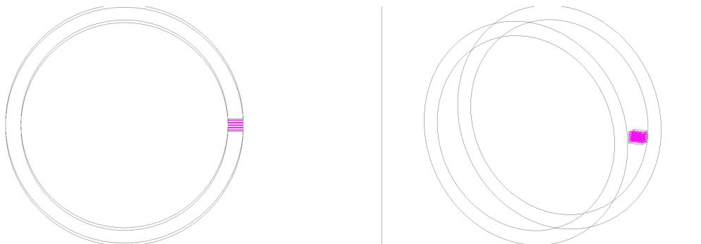
Slika 3.17: Model 1m. – 1 modul sa 4x4 kristala u PET konstrukciji
