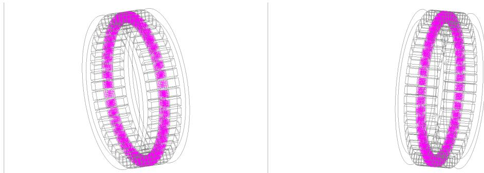
Slika 3.24: Model 2m+p – 48 modula sa 4x4 kristala po modulu u prstenastoj PET konstrukciji
