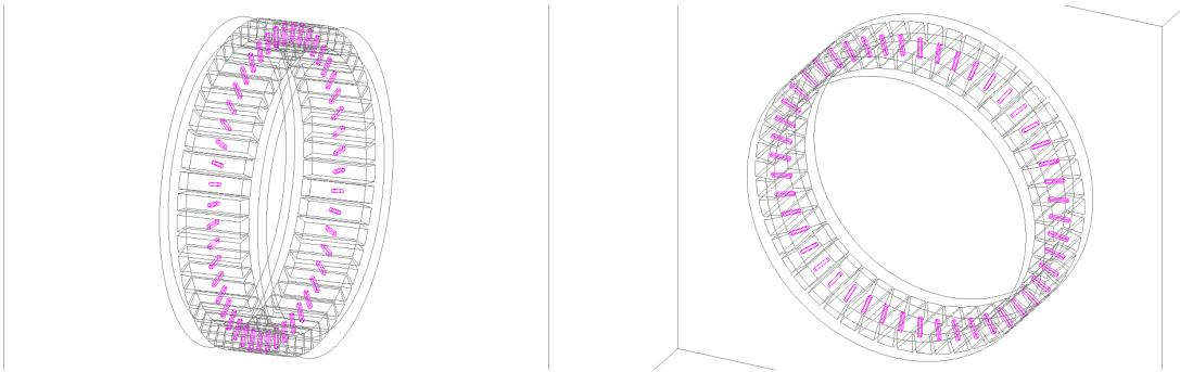
Slika 3.14: Model 2+p. – 48 kristala u prstenastoj PET konstrukciji
