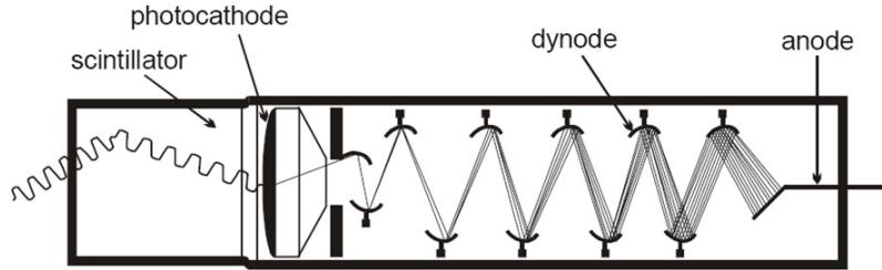
Slika 2.4: Shematski prikaz detektorskog sustava scintilatora i fotomultiplikatora [7]
