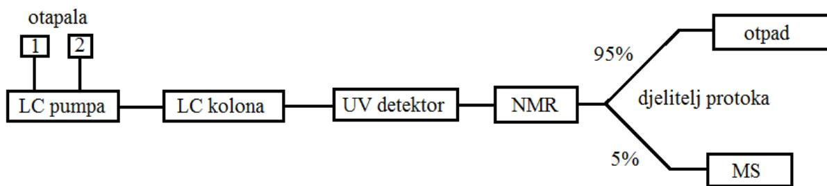
SLIKA 3. Prikaz serijskog povezivanja sustava LC-NMR-MS.
