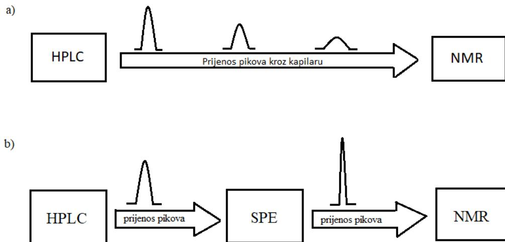
**SLIKA 1.** Shematski prikaz prijenosa pikova u spregnutim sustavima: a) LC-NMR,
