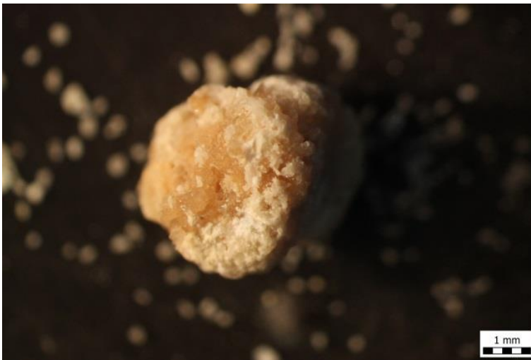
Slika 22. Uzorak Os3 pokazuje različite mineralne faze (razlika u boji), praškasta površina
