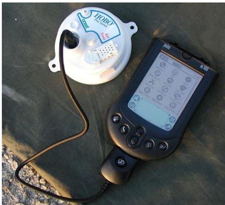
Slika 3. Memorijski termohigrograf i prijenosni čitač podataka. Izvor: Buzjak 2010.
