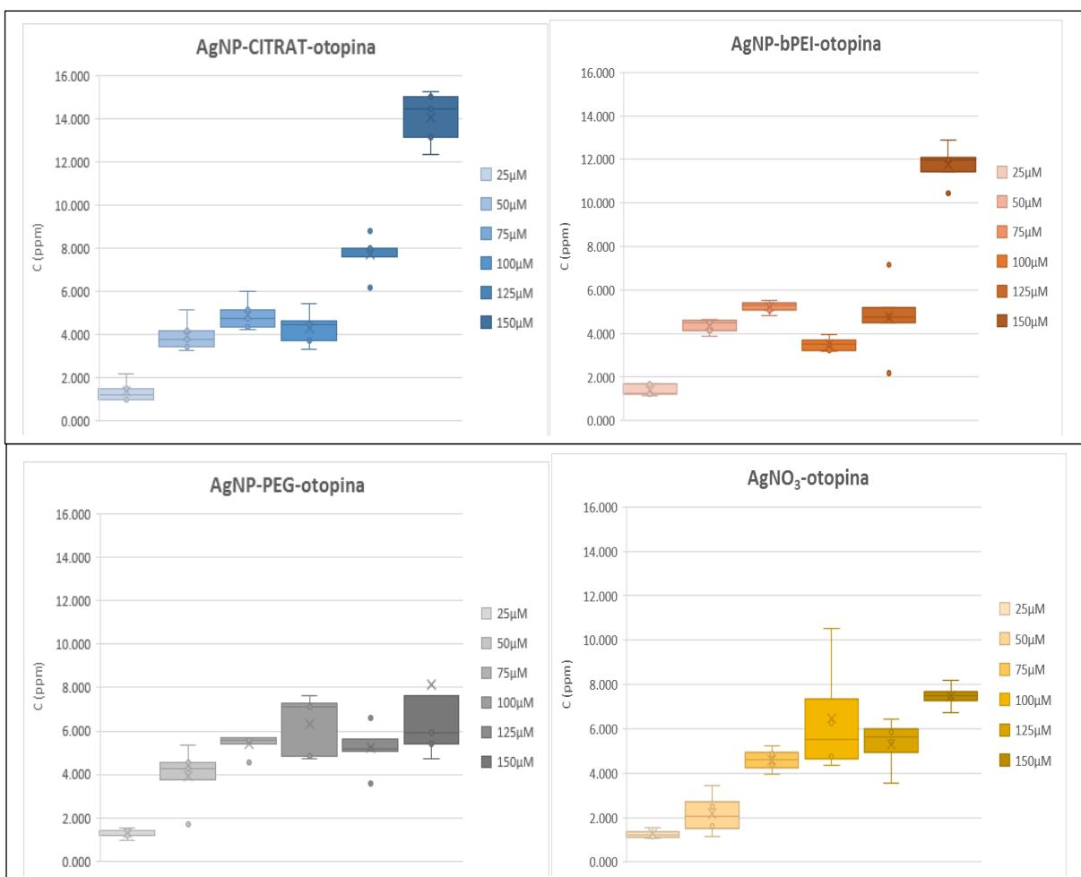
Slika 9. Box-plot dijagram koncentracija srebra u otopini u kojoj su klijale sjemenke duhana desetog dana tretmana s AgNP-citrat, AgNP-bPEI, AgNP-PEG i AgNO<sub>3</sub> pri koncentracijama 25  $\mu\text{M}$ , 50  $\mu\text{M}$ , 75  $\mu\text{M}$ , 100  $\mu\text{M}$ , 125  $\mu\text{M}$ , 150  $\mu\text{M}$ .
