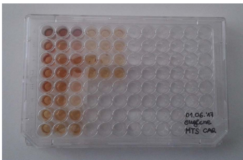
Slika 13. Pločica sa 96 jažica s triplikatima uzoraka nakon očitavanja absorbancije.
