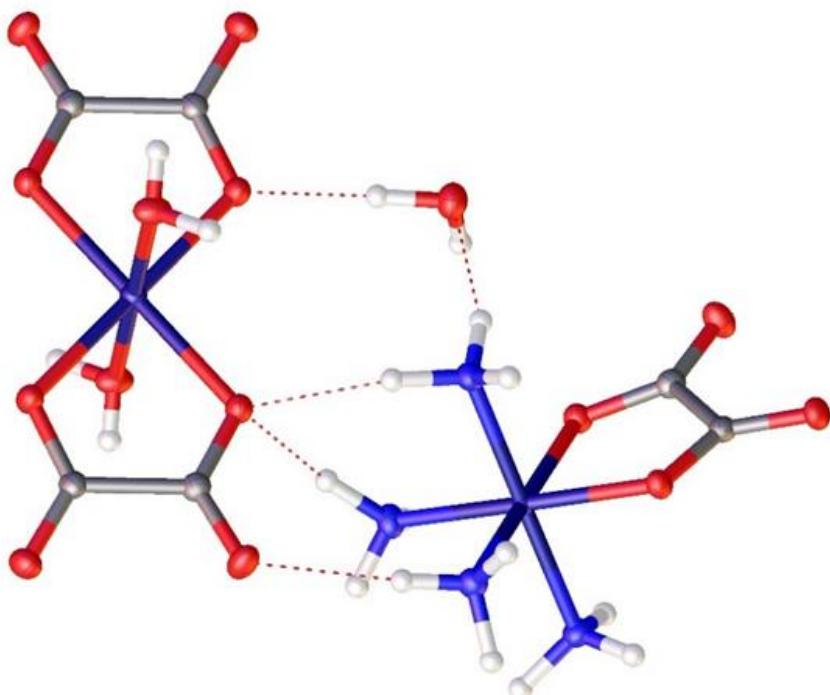
**Slika 23.** Molekulska i kristalna struktura spoja  $[\text{CoC}_2\text{O}_4(\text{NH}_3)_4][\text{Fe}(\text{C}_2\text{O}_4)_2(\text{OH}_2)_2] \cdot \text{H}_2\text{O}$ ; crvenim isprekidanim linijama prikazane su vodikove veze.
