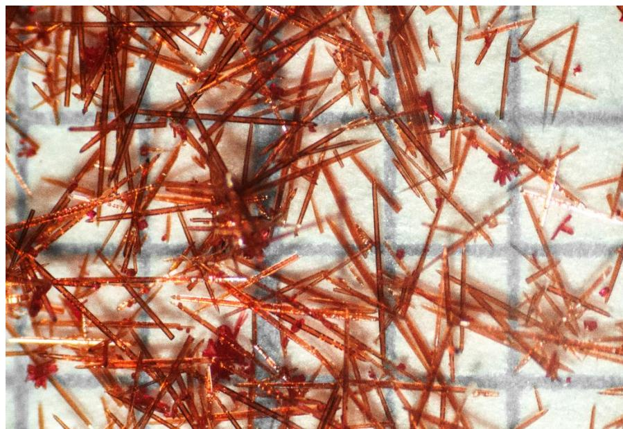
**Slika 25.** Mikrofotografija jediničnih kristala spoja  $[\text{Co}(\text{NH}_3)_6]\text{[Fe(C}_2\text{O}_4)_3]$ , prizmatske morfologije i igličastog habitusa (stranica kvadratična predstavlja duljinu 1 mm).
