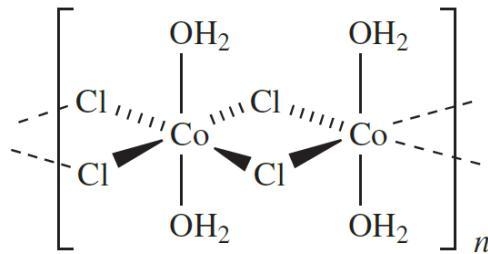
**Slika 15.**  $\text{CoCl}_2 \cdot 2\text{H}_2\text{O}$  građeni od lanca  $\{\text{CoCl}_4(\text{OH}_2)_2\}$  oktaedara.<sup>4</sup>
