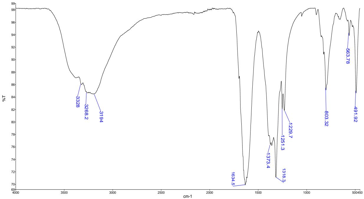
**Slika VI.** Infracrveni spektar spoja  $[\text{CoC}_2\text{O}_4(\text{NH}_3)_4][\text{Fe}(\text{C}_2\text{O}_4)_2(\text{OH}_2)_2] \cdot 2\text{H}_2\text{O}$ , dobivenog starenjem smjese čvrstih ishodnih spojeva u atmosferi s visokim udjelom relativne vlažnosti (sinteza 3.5.2.).
