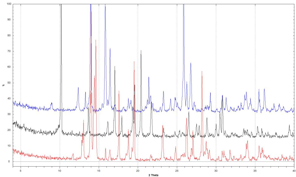
**Slika xxv.** Difraktogram praha spoja spoja  $[\text{Co}(\text{NH}_3)_6]\text{[Fe(C}_2\text{O}_4)_3]$  (crno), monohidrata (crveno) i dihidrata (plavo) spoja  $[\text{CoC}_2\text{O}_4(\text{NH}_3)_4]\text{[Fe(C}_2\text{O}_4)_2(\text{OH}_2)_2]$ . Monohidratna sol produkt je sinteze 3.3.3. (refluks); dihidratna sol je produkt sinteze 3.4.1. (sobna temperatura); spoj  $[\text{Co}(\text{NH}_3)_6]\text{[Fe(C}_2\text{O}_4)_3]$  je produkt sinteze 3.3.2. (sobna temperatura).
