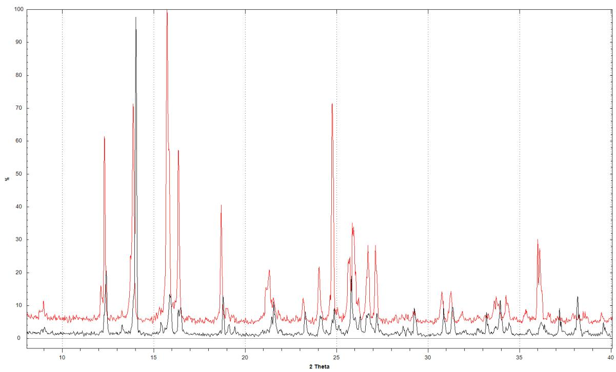
**Slika VIII.** Difraktogram praha spoja  $[\text{CoC}_2\text{O}_4(\text{NH}_3)_4][\text{Fe}(\text{C}_2\text{O}_4)_2(\text{OH}_2)_2] \cdot 2\text{H}_2\text{O}$  dobivenog pri sobnoj temperaturi, u sintezi 3.3.2. (crno) i generirani difraktogram praha za isti spoj (crveno).
