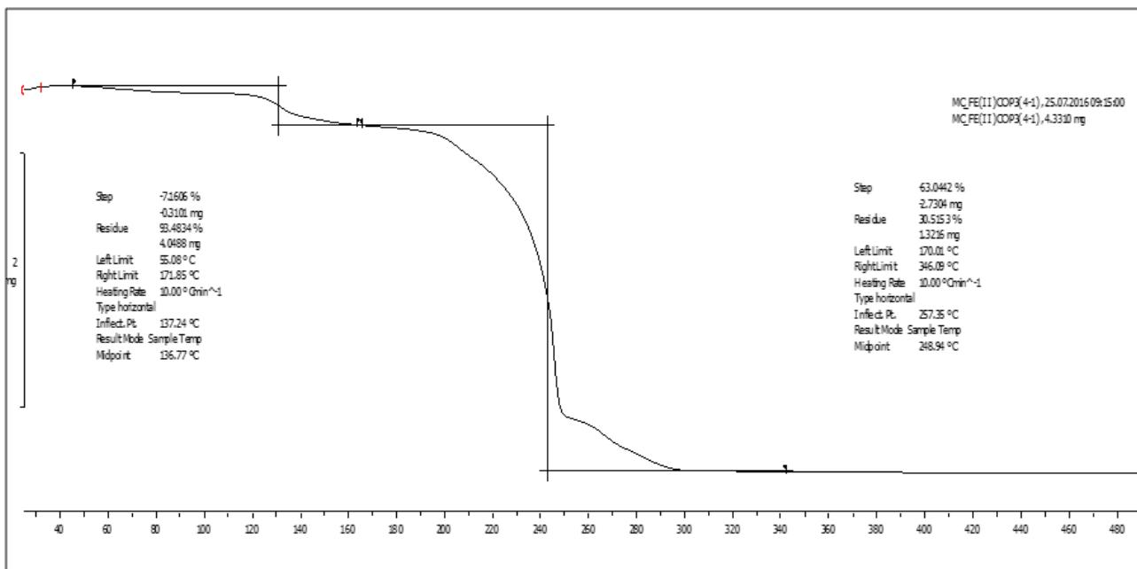
**Slika XIII.** TGA termogram za spoj  $[\text{CoC}_2\text{O}_4(\text{NH}_3)_4][\text{Fe}(\text{C}_2\text{O}_4)_2(\text{OH}_2)_2] \cdot 2\text{H}_2\text{O}$ .
