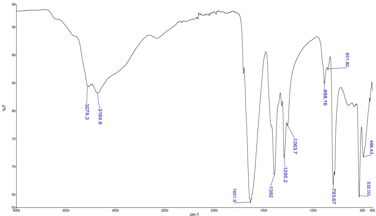
**Slika XXIII.** Infracrveni spektar spoja  $[\text{Co}(\text{NH}_3)_6]\text{[Fe(C}_2\text{O}_4)_3]$ , dobiven pri sobnoj temperaturi (sinteza 3.4.1.)
