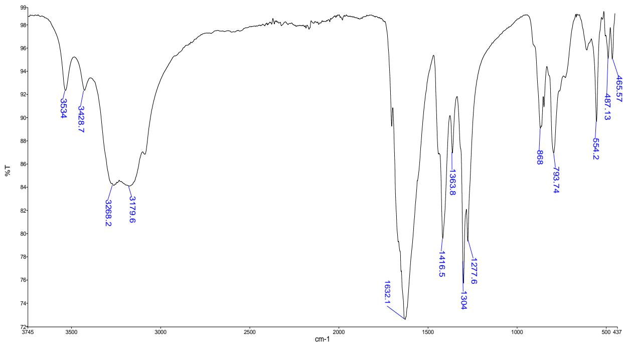
**Slika 1.** Infracrveni spektar spoja  $[\text{CoC}_2\text{O}_4(\text{NH}_3)_4][\text{Fe}(\text{C}_2\text{O}_4)_2(\text{OH}_2)_2] \cdot 2\text{H}_2\text{O}$ , dobivenog pri sobnoj temperaturi (sinteza 3.3.1.).
