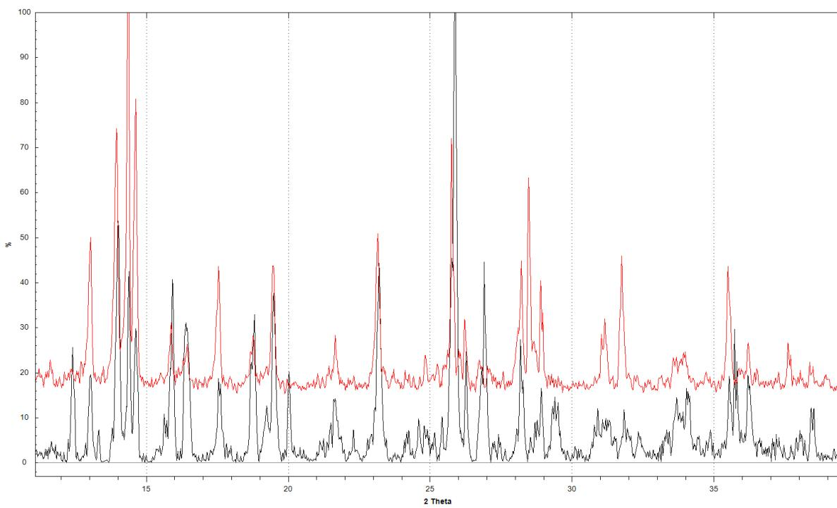
**Slika xix.** Difraktogram praha spoja  $[\text{CoC}_2\text{O}_4(\text{NH}_3)_4]\text{[Fe(C}_2\text{O}_4)_2(\text{OH}_2)_2] \cdot \text{H}_2\text{O}$  dobivenog hidrotermalnim putem, u sintezi 3.6.1. (crno) i generirani difraktogram praha za isti spoj (crveno).
