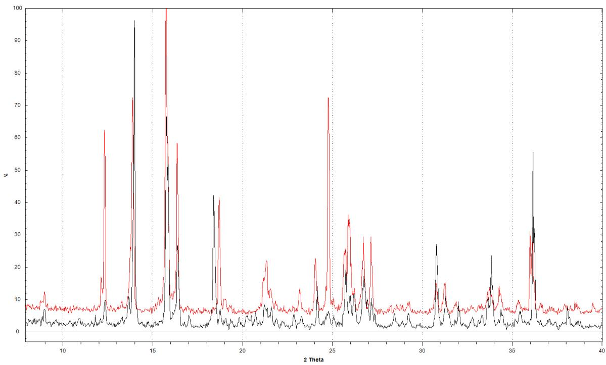
**Slika IX.** Difraktogram praha spoja  $[\text{CoC}_2\text{O}_4(\text{NH}_3)_4][\text{Fe}(\text{C}_2\text{O}_4)_2(\text{OH}_2)_2] \cdot 2\text{H}_2\text{O}$  dobivenog uz refluks, u sintezi 3.3.3. (crno) i generirani difraktogram praha za isti spoj (crveno).
