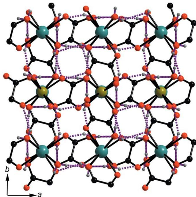
**Slika 9.** Prikaz dijela kristalne strukture  $[NaFe(C_2O_4)_2(H_2O)_4]_n$  duž kristalografske osi  $c$ . Lanci kationskih poliedara premošteni oksalatnim jedinicama prostiru se duž kristalografskih smjerova  $a$  i  $b$  tvoreći tunele duž smjera  $c$ ; plavozeleno – natrijev kation; zelenožuto – željezov(III) ion; crveno – kisik; crno – ugljik; ljubičasto – vodik; ljubičasto iscrtkano – vodikove veze.<sup>15</sup>
