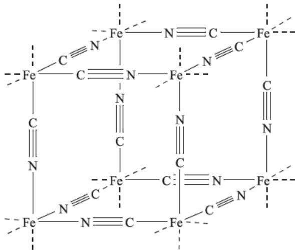
**Slika 5.** Osmina jedinične ćelije topljivog berlinskog modrila –  $\text{KFe}[\text{Fe}(\text{CN})_6]$ . Isti struktturni motiv je zastupljen i kod klasičnog berlinskog kao i Turnbullovog modrila.<sup>4</sup>
