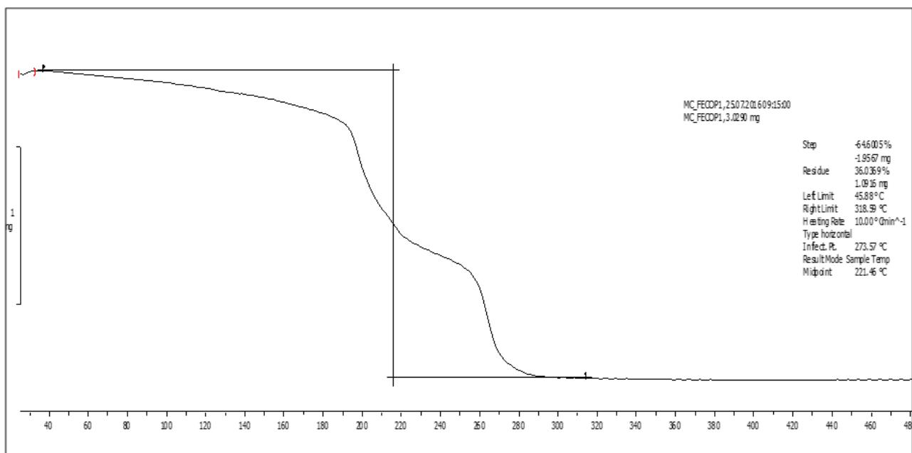
Slika XXIX. TGA termogram za spoj  $[\text{Co}(\text{NH}_3)_6][\text{Fe}(\text{C}_2\text{O}_4)_3]$ .
