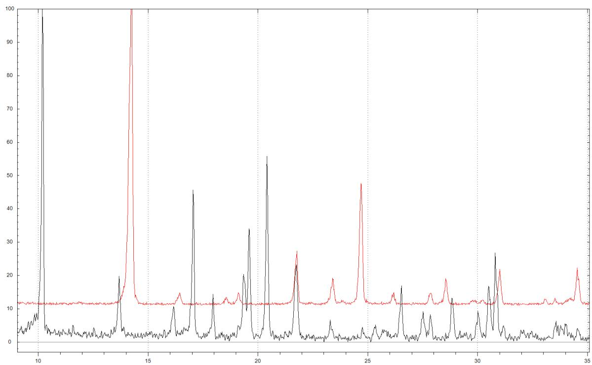
**Slika XXVIII.** Difraktogram praha spoja  $[\text{Co}(\text{NH}_3)_6]\text{[Fe(C}_2\text{O}_4)_3]$  (crno) dobivenog u sintezi 3.3.2.; generirani difraktogram praha za isti spoj (crveno).
