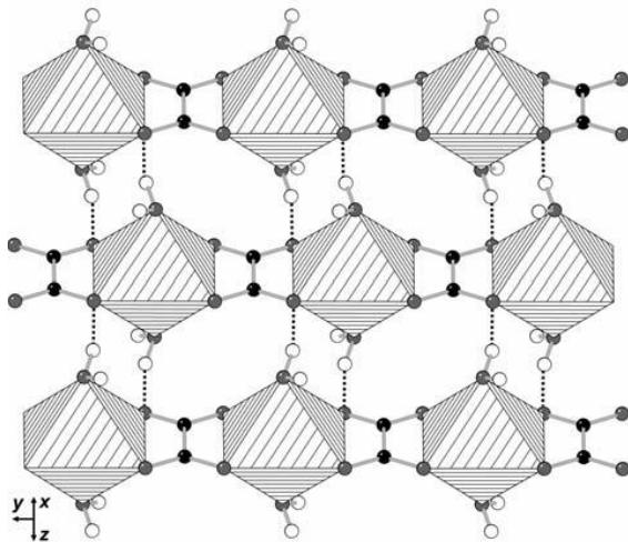
**Slika 7.** Kristalna struktura  $[\text{FeC}_2\text{O}_4(\text{OH}_2)_2]$ . Prugasto istaknuto – kationski poliedar, crno – ugljik, sivo – kisik, bijelo – vodik, iscrtkano – vodikove veze.<sup>14</sup>
