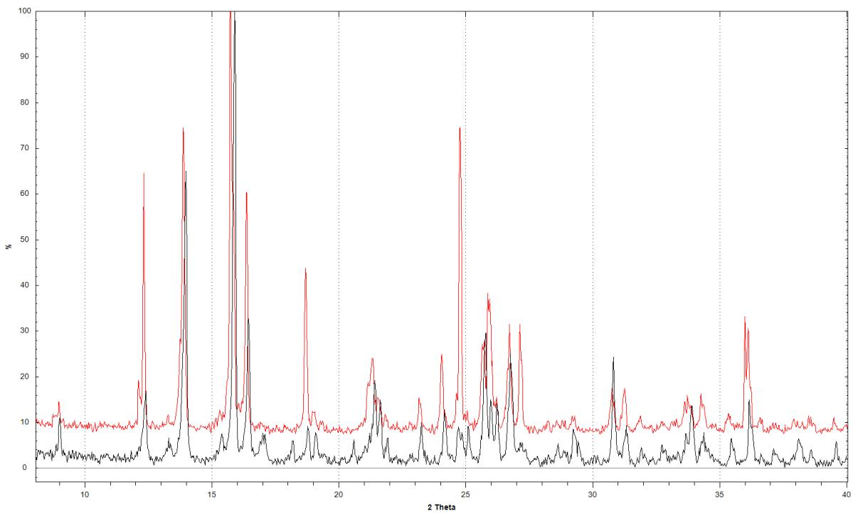
**Slika XI.** Difraktogram praha spoja  $[\text{CoC}_2\text{O}_4(\text{NH}_3)_4][\text{Fe}(\text{C}_2\text{O}_4)_2(\text{OH}_2)_2] \cdot 2\text{H}_2\text{O}$  dobivenog pri sobnoj temperaturi, u sintezi 3.4.1. (crno) i generirani difraktogram praha za isti spoj (crveno).
