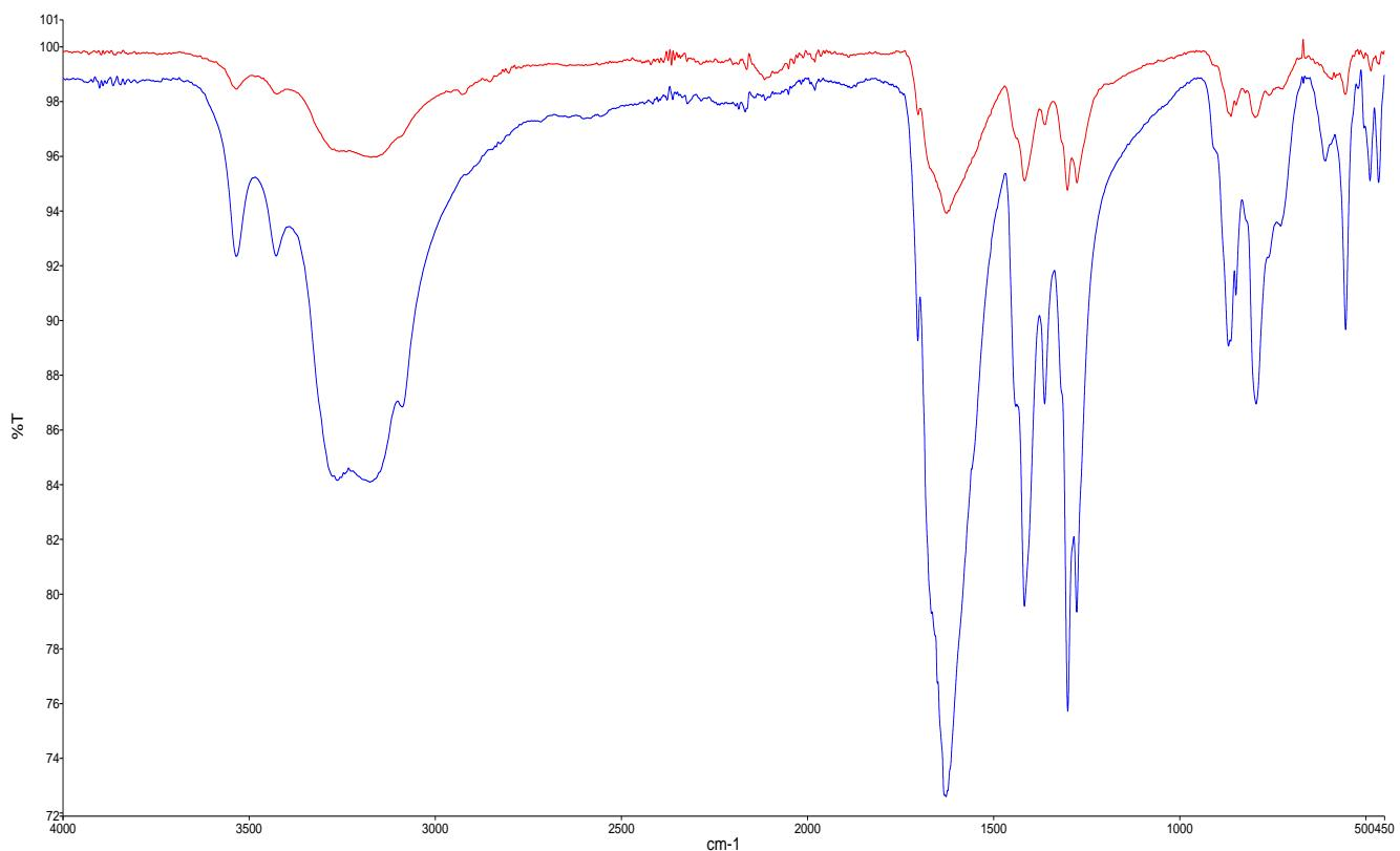
**Slika XV.** Infracrveni spektri monohidrata (crveno) i dihidrata (plavo) spoja  $[\text{CoC}_2\text{O}_4(\text{NH}_3)_4][\text{Fe}(\text{C}_2\text{O}_4)_2(\text{OH}_2)_2]$ . Monohidratna sol produkt je sinteze 3.3.3. (refluks); dihidratna sol je produkt sinteze 3.3.1. (sobna temperatura).
