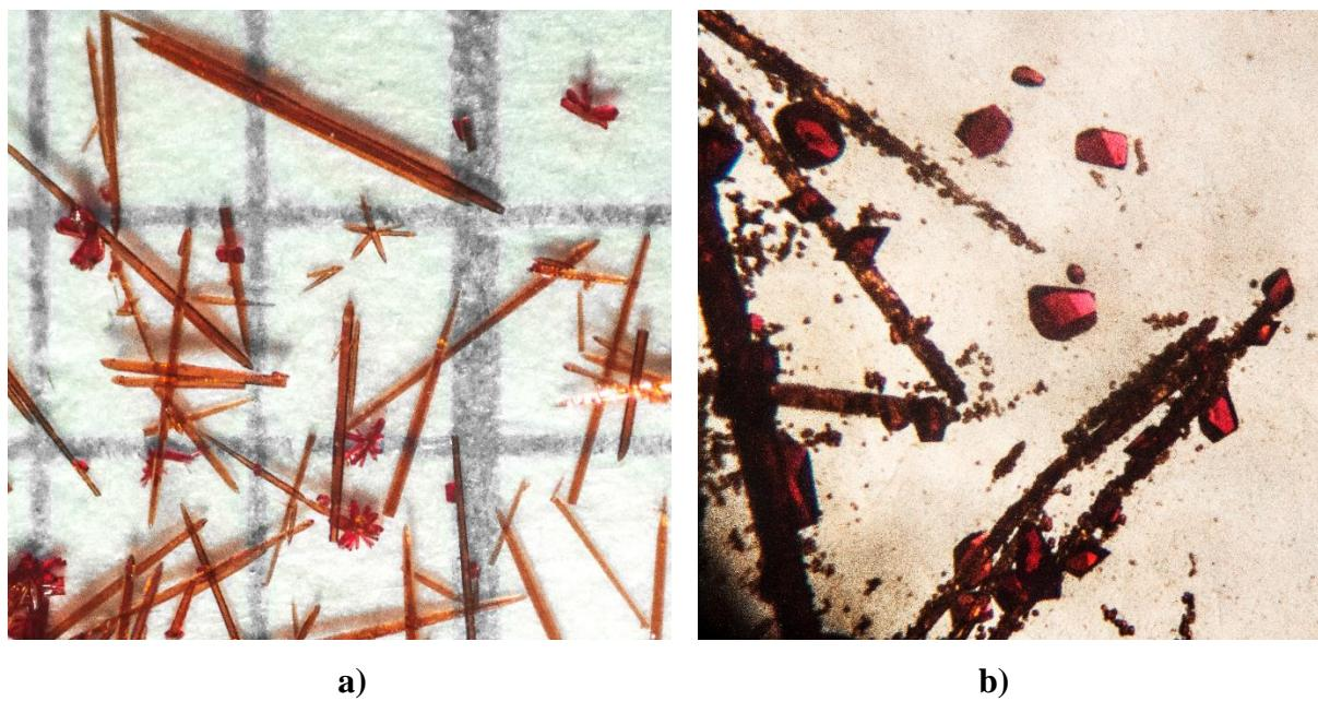
**Slika 26.** Mikrofotografija transformacije jediničnih kristala spoja  $[\text{Co}(\text{NH}_3)_6]\text{[Fe(C}_2\text{O}_4)_3]$  u kristale spoja  $[\text{CoC}_2\text{O}_4(\text{NH}_3)_4]\text{[Fe(C}_2\text{O}_4)_2(\text{OH}_2)_2 \cdot 2\text{H}_2\text{O]}$ . a) stanje nakon jednog dana starenja u matičnici (stranica kvadratična predstavlja duljinu 1 mm) b) stanje nakon dva dana starenja u matičnici (10x uvećanje).
