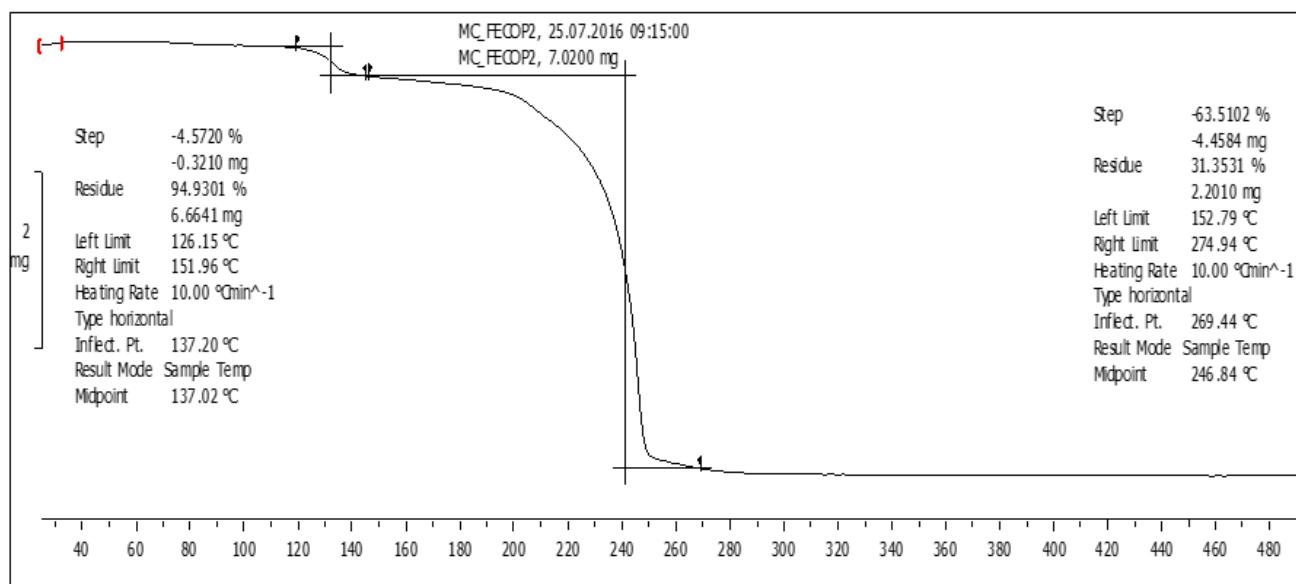
**Slika XXI.** TGA termogram za spoj  $[\text{CoC}_2\text{O}_4(\text{NH}_3)_4][\text{Fe}(\text{C}_2\text{O}_4)_2(\text{OH}_2)_2] \cdot \text{H}_2\text{O}$ .
