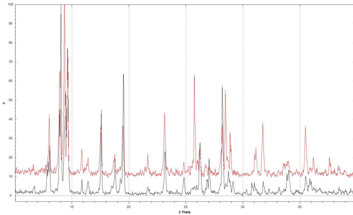
**Slika XVII.** Difraktogram praha spoja  $[\text{CoC}_2\text{O}_4(\text{NH}_3)_4][\text{Fe}(\text{C}_2\text{O}_4)_2(\text{OH}_2)_2] \cdot \text{H}_2\text{O}$  dobivenog hidrotermalnim putem, u sintezi 3.4.3. (crno) i generirani difraktogram praha za isti spoj (crveno).
