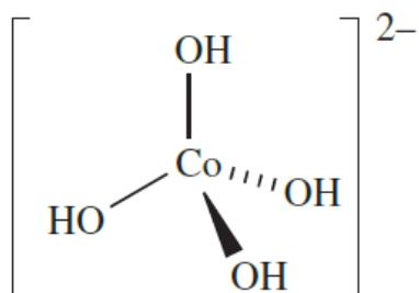
**Slika 10.**  $[\text{Co}(\text{OH})_4]^-$  kompleksna vrsta nastala otapanjem  $\text{Co(OH)}_2$  u suvišku lužine.<sup>4</sup>
