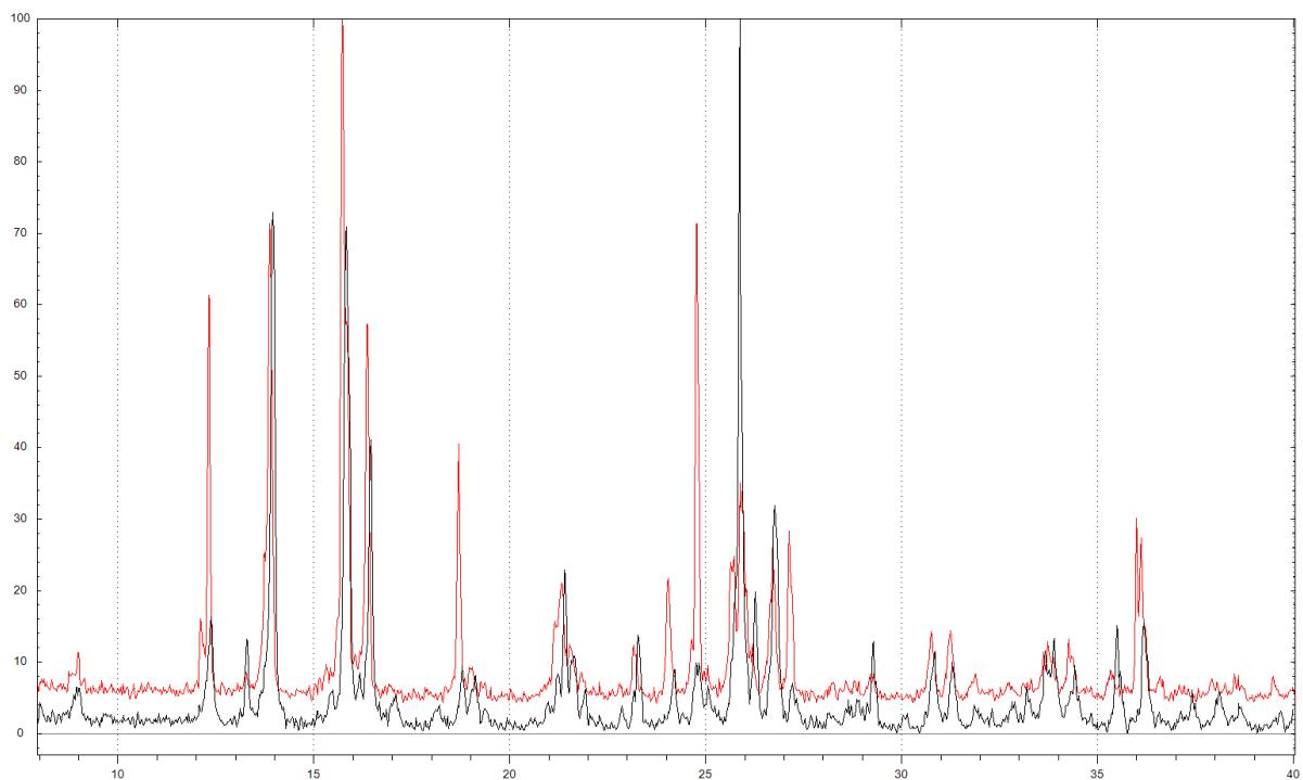
**Slika VII.** Difraktogram praha spoja  $[\text{CoC}_2\text{O}_4(\text{NH}_3)_4][\text{Fe}(\text{C}_2\text{O}_4)_2(\text{OH}_2)_2] \cdot 2\text{H}_2\text{O}$  dobivenog pri sobnoj temperaturi, u sintezi 3.3.1. (crno) i generirani difraktogram praha za isti spoj (crveno).
