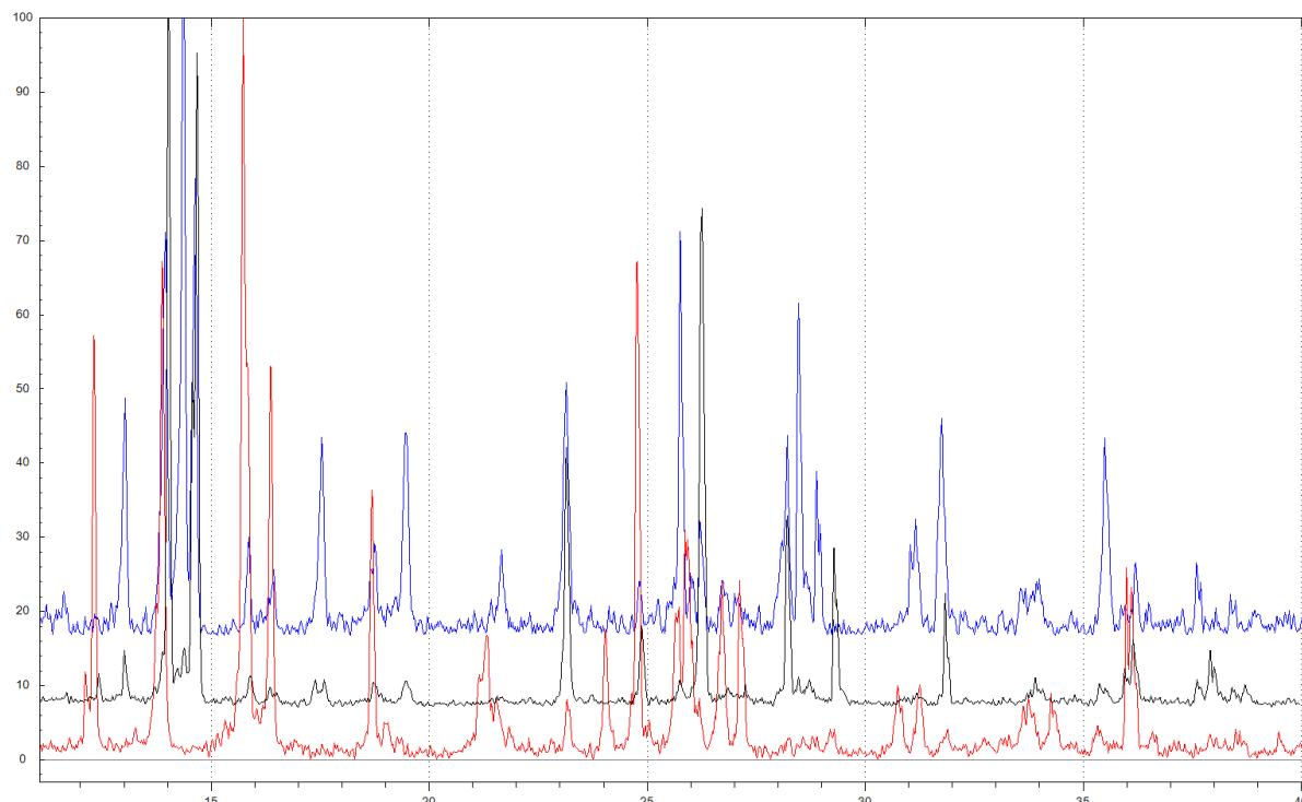
**Slika XVIII.** Difraktogram praha smjese mono- i dihidrata spoja  $[\text{CoC}_2\text{O}_4(\text{NH}_3)_4][\text{Fe}(\text{C}_2\text{O}_4)_2(\text{OH}_2)_2]$ , dobivenih uz refluks, u sintezi 3.5.1. (crno); generirani difraktogram praha za dihidratnu sol (crveno) i za monohidratnu sol (plavo).
