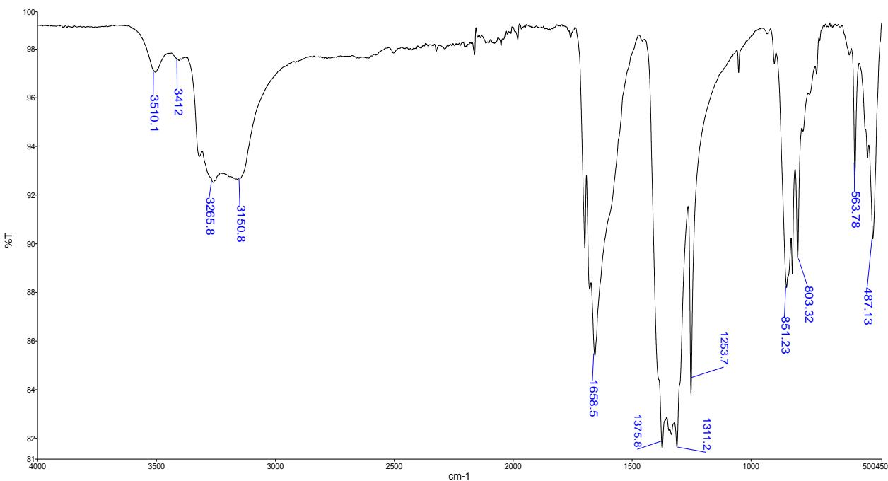
**Slika III.** Infracrveni spektar spoja  $[\text{CoC}_2\text{O}_4(\text{NH}_3)_4][\text{Fe}(\text{C}_2\text{O}_4)_2(\text{OH}_2)_2] \cdot 2\text{H}_2\text{O}$ , dobivenog starenjem smjese čvrstih ishodnih spojeva u atmosferi s visokim udjelom relativne vlažnosti (sinteza 3.3.5.).
