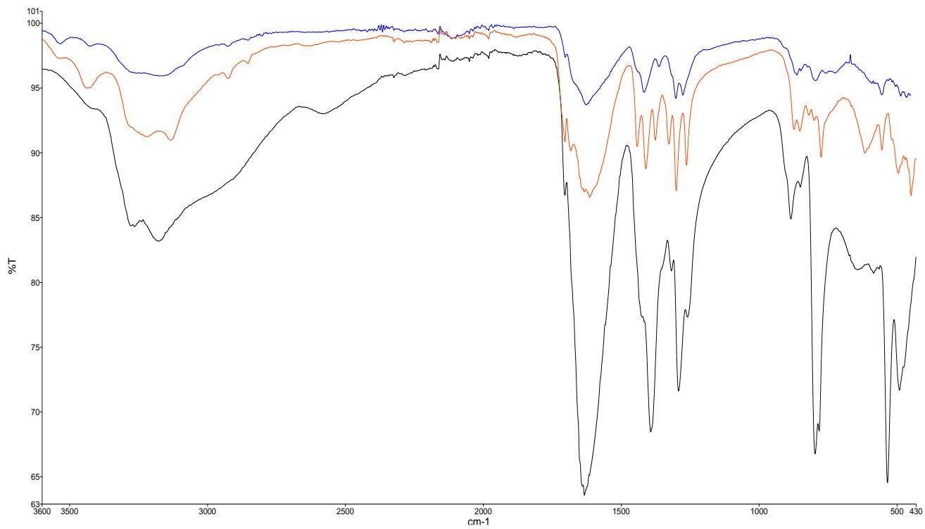
**Slika XXIV.** Infracrveni spektri spoja  $[\text{Co}(\text{NH}_3)_6][\text{Fe}(\text{C}_2\text{O}_4)_3]$  (crno), monohidrata (plavo) i dihidrata (crveno) spoja  $[\text{CoC}_2\text{O}_4(\text{NH}_3)_4][\text{Fe}(\text{C}_2\text{O}_4)_2(\text{OH}_2)_2]$ . Monohidratna sol produkt je sinteze 3.3.3. (refluks); dihidratna sol je produkt sinteze 3.4.1. (sobna temperatura), kao i spoj  $[\text{Co}(\text{NH}_3)_6][\text{Fe}(\text{C}_2\text{O}_4)_3]$ .
