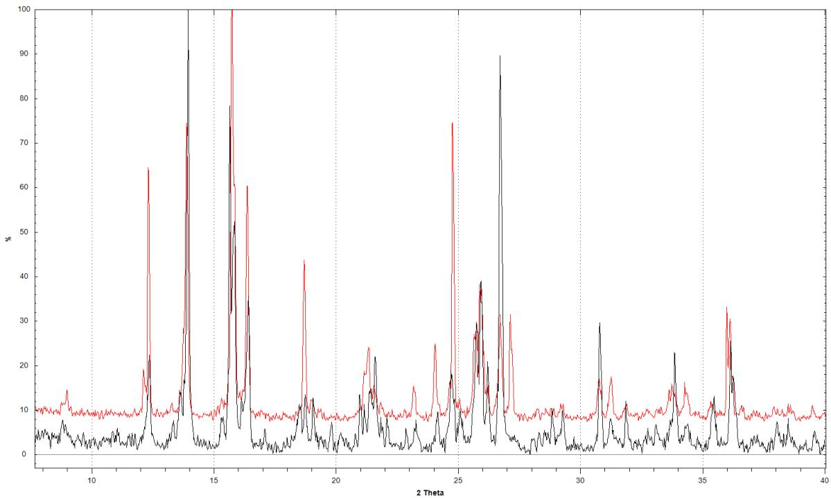
**Slika X.** Difraktogram praha spoja  $[\text{CoC}_2\text{O}_4(\text{NH}_3)_4][\text{Fe}(\text{C}_2\text{O}_4)_2(\text{OH}_2)_2] \cdot 2\text{H}_2\text{O}$  dobivenog hidrotermalnim putem, u sintezi 3.3.4. (crno) i generirani difraktogram praha za isti spoj (crveno).
