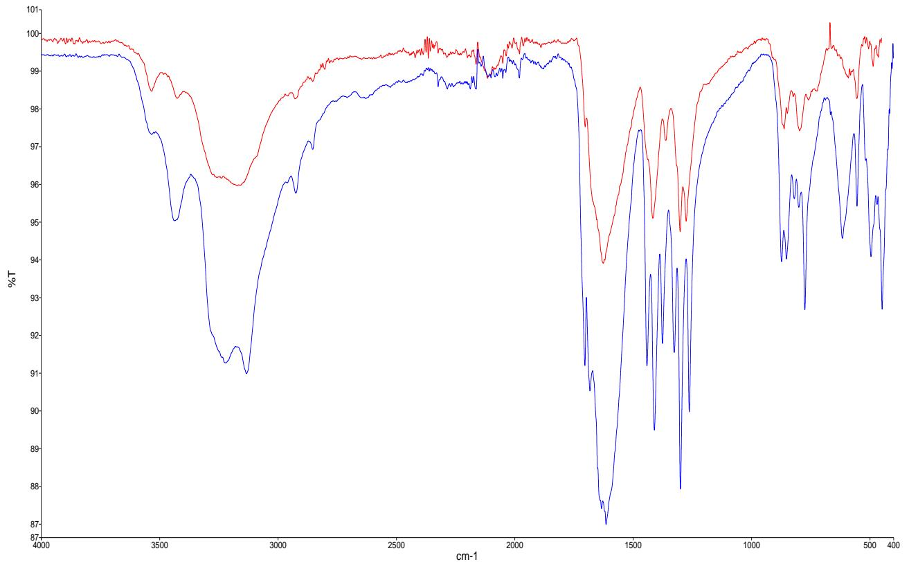
**Slika XVI.** Infracrveni spektri monohidrata (crveno) i dihidrata (plavo) spoja  $[\text{CoC}_2\text{O}_4(\text{NH}_3)_4][\text{Fe}(\text{C}_2\text{O}_4)_2(\text{OH}_2)_2]$ . Monohidratna sol produkt je sinteze 3.3.3. (refluks); dihidratna sol je produkt sinteze 3.4.1. (sobna temperatura).
