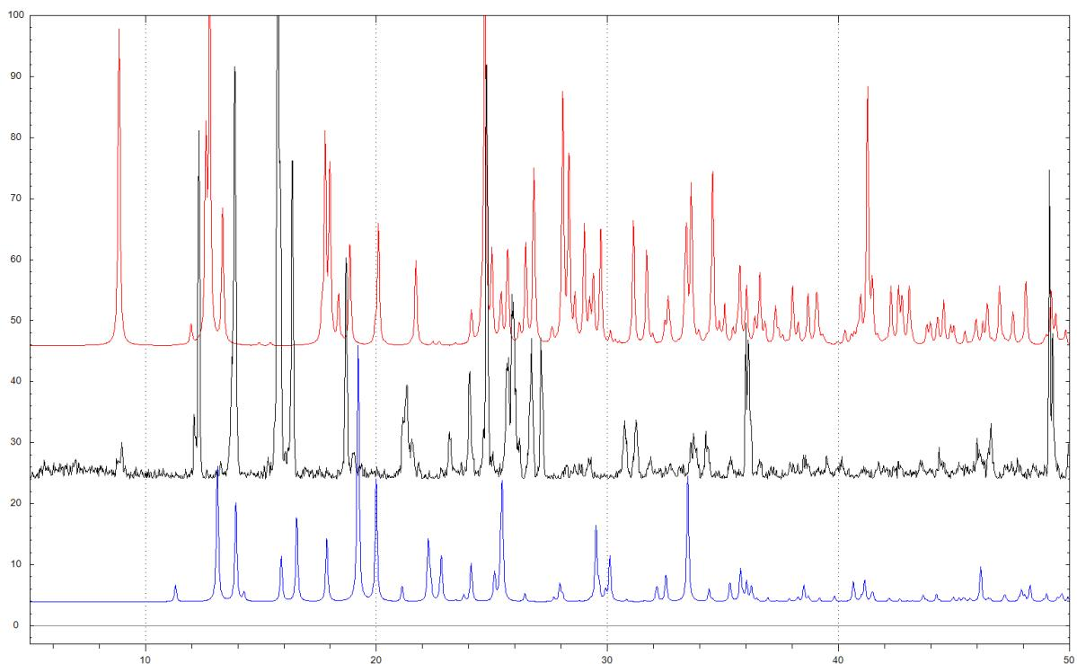
**Slika XII.** Generirani difraktogrami praha spojeva  $[\text{CoC}_2\text{O}_4(\text{NH}_3)_4][\text{Fe}(\text{C}_2\text{O}_4)_2(\text{OH}_2)_2] \cdot 2\text{H}_2\text{O}$  (crno),  $\text{K}_3[\text{Fe}(\text{C}_2\text{O}_4)_3] \cdot 3\text{H}_2\text{O}$  (crveno) i  $[\text{CoC}_2\text{O}_4(\text{NH}_3)_4]\text{NO}_3 \cdot \text{H}_2\text{O}$  (plavo).
