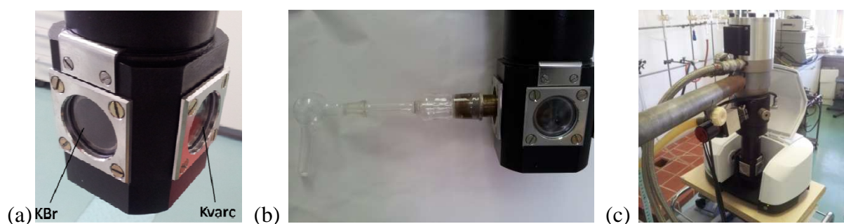
Slika 31. Kriostat: (a) prozori od KBr i kvarca; (b) aparatura za epitaksiju; (c) položaj kriostata prilikom snimanja IR spektara.
