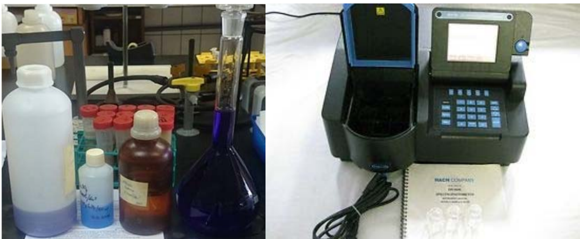
Slika 16. a) Pripremljeni standard za izradu kalibracijske krivulje za potrebe CEC mjerenja b) Spektrofotometar HACH DR/4000.
