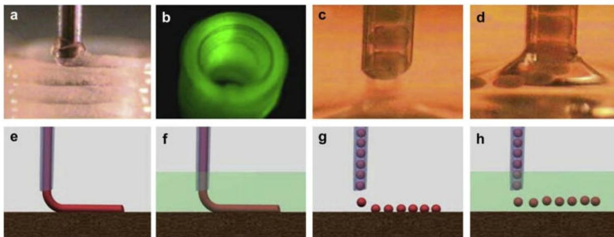
**Slika 8.** Kontinuirano i digitalno printanje. (a,e) Printanje kontinuiranih linija stanica na ekstracelularni matriks (ECM). (b,f) Printanje kontinuiranih linija stanica u mediju. (c,g) Printanje agregata na ECM. (d,h) Printanje agregata u mediju. (Preuzeto i prilagođeno iz Mironov i sur., 2009)
