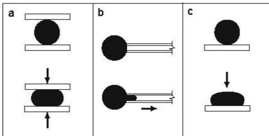
**Slika 6.** Metode kvantitativne evaluacije materijalnih svojstava tkivnih sferoida. (a) Tenziometrija – kontrolirana kompresija staničnih agregata između dvije paralelne ploče. Ograničenje ovog pristupa je zahtjev idealnog sferičnog oblika. (b) Aspiracija. (c) Centrifugiranje (preuzeto s [downloads.deusm.com](http://downloads.deusm.com)).
