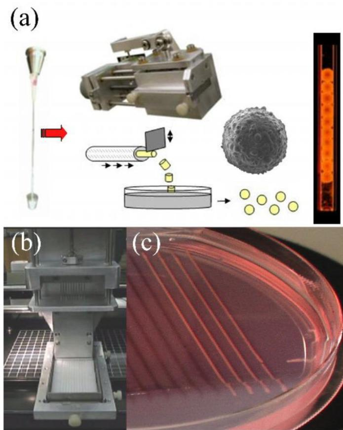
**Slika 4.** Priprema višestaničnih građevnih blokova. (a) Priprema tkivnih sferoida. (b,c) Priprema cilindričnih građevnih blokova. Istovremeno do 10 staničnih smjesa u agaroznom kalupu sazrijeva u cilindre dovoljno čvrste za printanje (preuzeto iz Jakab i sur., 2010).
