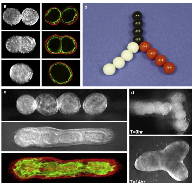
**Slika 13.** Primjer upotrebe monoluminiziranih tkivnih sferoida za printanje segmenata intraorganskog vaskularnog stabla. (a) Fuzija tkivnih sferoida. (b) Model za izradu razgranatih vaskularnih segmenata od monoluminiziranih tkivnih sferoida. (c) Uzastopni koraci fuzije tkivnih sferoida u hidrogelu. (d) Dobiveni razgranati vaskularni segmenti prije (gore) i nakon tkivne fuzije (dolje) (preuzeto iz Mironov i sur., 2009).
