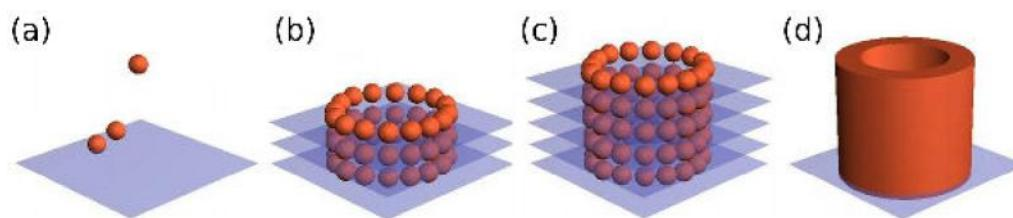
**Slika 5.** Nanošenje biotinte. (a) Na ispisani list biopapira polažu se čestice biotinte. (b,c) Slojevi biokompatibilnog hidrogela i građevni blokovi nastavljaju se naizmjenice nanositi prema nacrtu za izgradnju željene 3D strukture (ovdje: tubularni konstrukt). (d) Konstrukt dobiven nakon fuzije građevnih blokova i uklanjanja hidrogela nakon nekoliko dana (preuzeto iz Jakab i sur., 2010).
