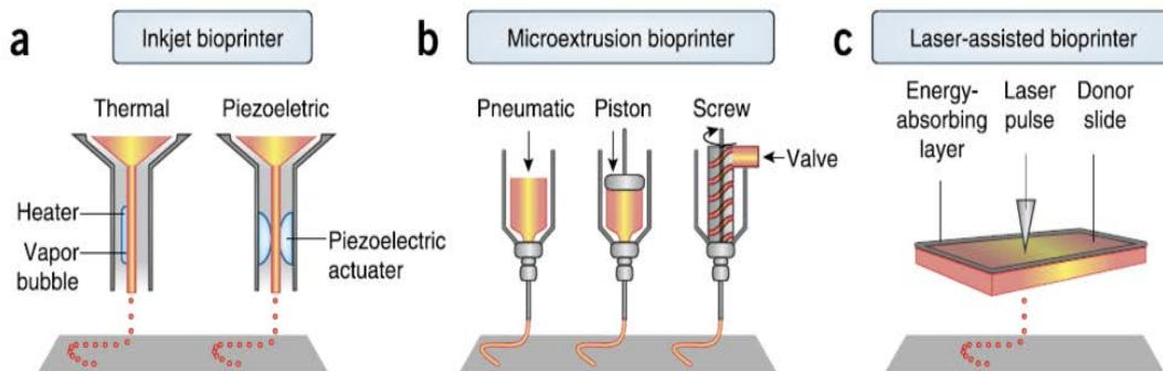
Slika 7. Komponente različitih vrsta bioprintera. (a) Tintni, (b) mikroekstruzijski i (c) laserski pisač (preuzeto iz Murphy i Atala 2014).
