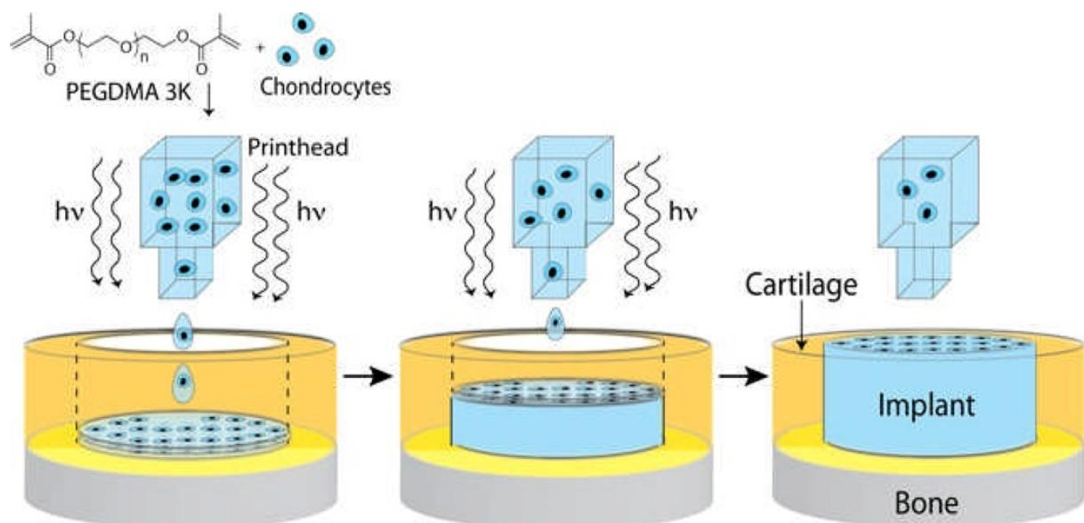
**Slika 10.** Shematski prikaz bioprintanja hrskavice uz simultanu fotopolimerizaciju (preuzeto iz Cui i sur., 2012).
