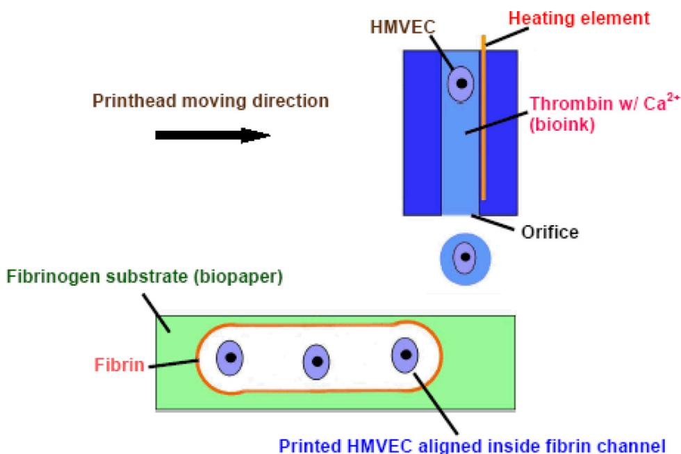
**Slika 11.** Shema mehanizma izrade mikrovaskulature simultanim polaganjem HMVEC stanica i fibrina pomoću termalnog tintnog pisača. Trombin služi za polimerizaciju fibrina. Polaganje stanica biotine odvija se istovremeno sa formiranjem fibrinskog kanala. Stanice poredane u fibrinskom kanalu spremne su za proliferaciju (preuzeto iz Cui i sur., 2012).
