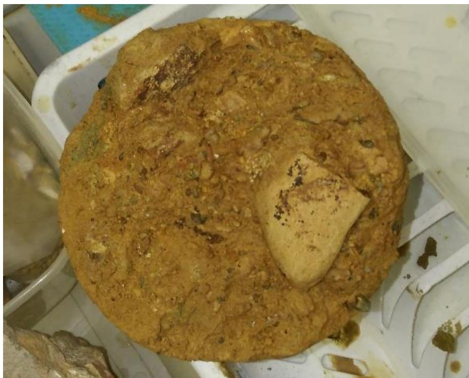
**Slika 5.** Slomljeni klast u glinovito-siltnom matriksu.
