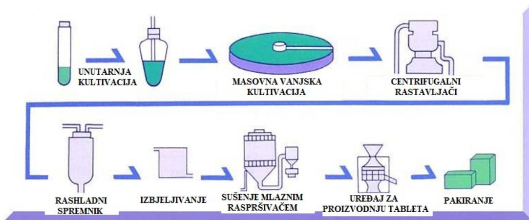
Slika 7. Shematski prikaz polikontinuiranog uzgoja alge *Chlorella* sp.
