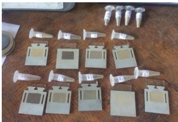
Slika 6. Pripremljeni uzorci u Al-nosačima
