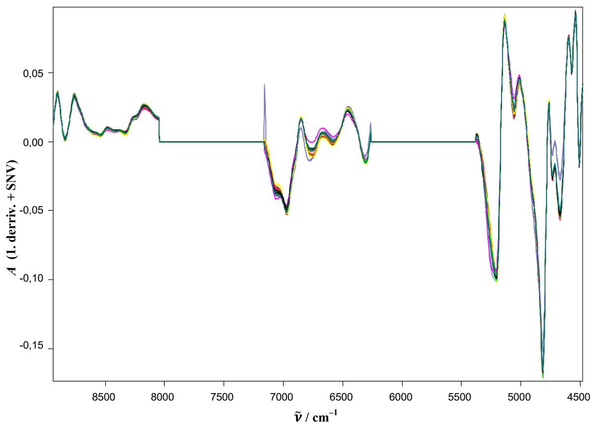
Slika 57. Matematički obrađeni NIR spektri uzoraka u spektralnom području 8937–8046  $\text{cm}^{-1}$ , 7158,9–6264  $\text{cm}^{-1}$  i 5380,7–4482  $\text{cm}^{-1}$ , uključenih u kalibracijski model za 5. minutu oslobađanja.
