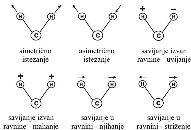
Slika 2. Osnovni načini vibriranja molekula.
