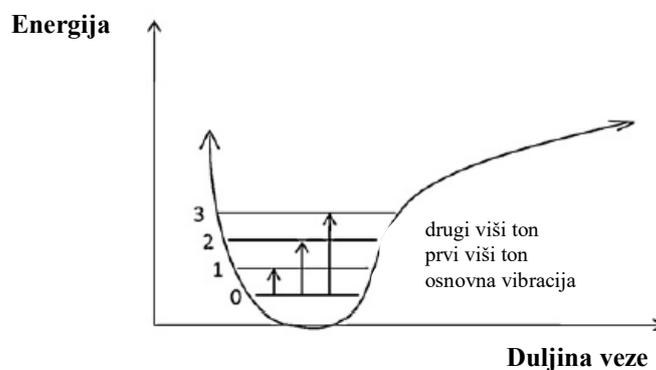
Slika 3. Anharmonički vibracijski model.<sup>50</sup>
