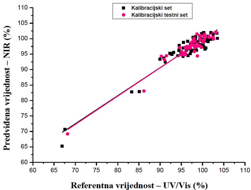
Slika 53. Ovisnost predviđenih vrijednosti o referentnim vrijednostima oslobođenog alopurinola iz tableta kalibracijskog seta i kalibracijskog testnog seta (unutarnja validacija) za 30. minutu oslobađanja.
