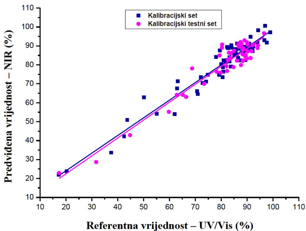
Slika 61. Ovisnost predviđenih vrijednosti o referentnim vrijednostima oslobođenog alopurinola iz tableta kalibracijskog seta i kalibracijskog testnog seta (unutarnja validacija) za 10. minutu oslobađanja.
