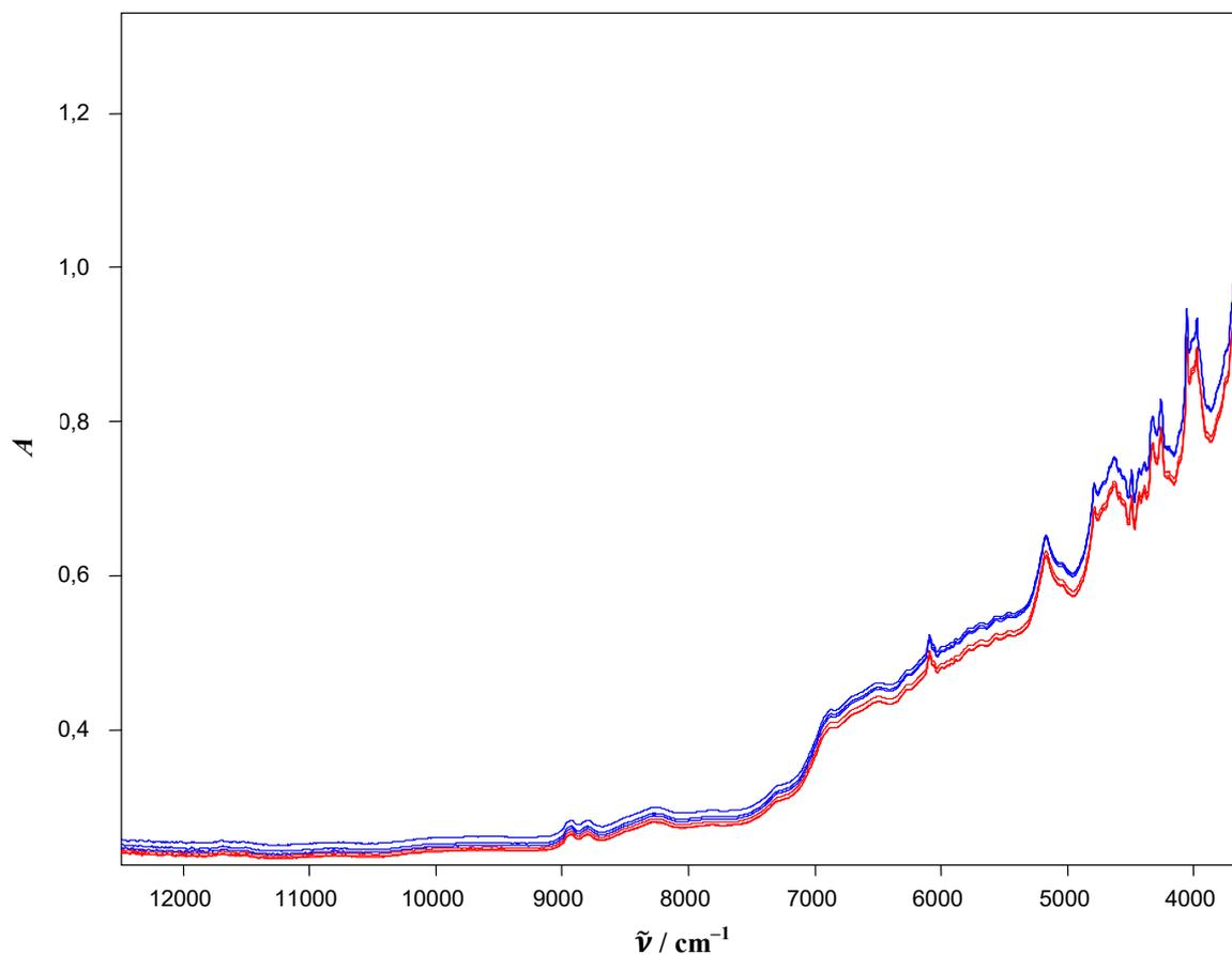
Slika 35. NIR spektri tableta alopurinola doze 200 mg serije C4 (20–25 °C, plavo) i C4ST (40±2 °C i 75±5% RV, crveno) snimljeni difuznom refleksijom zračenja u spektralnom području  $12500\text{--}3600\text{ cm}^{-1}$ .
