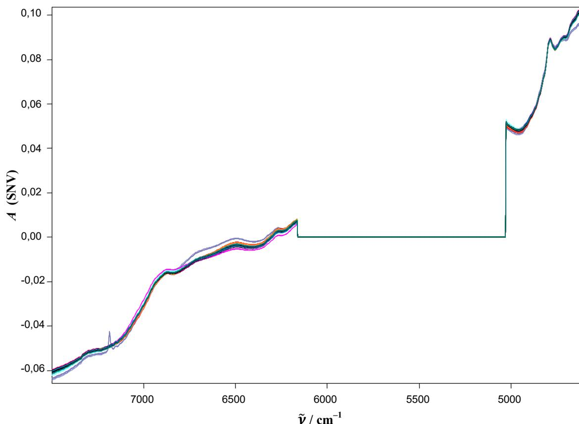
Slika 52. Matematički obrađeni NIR spektri uzoraka u spektralnom području 7498,3–6163,7  $\text{cm}^{-1}$  i 5025,9–4597,7  $\text{cm}^{-1}$ , uključenih u kalibracijski model za 45. minutu oslobađanja.
