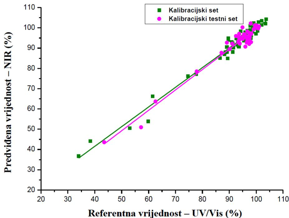
Slika 50. Ovisnost predviđenih vrijednosti o referentnim vrijednostima oslobođenog alopurinola iz tableta kalibracijskog seta i kalibracijskog testnog seta (unutarnja validacija) za 20. minutu oslobađanja.
