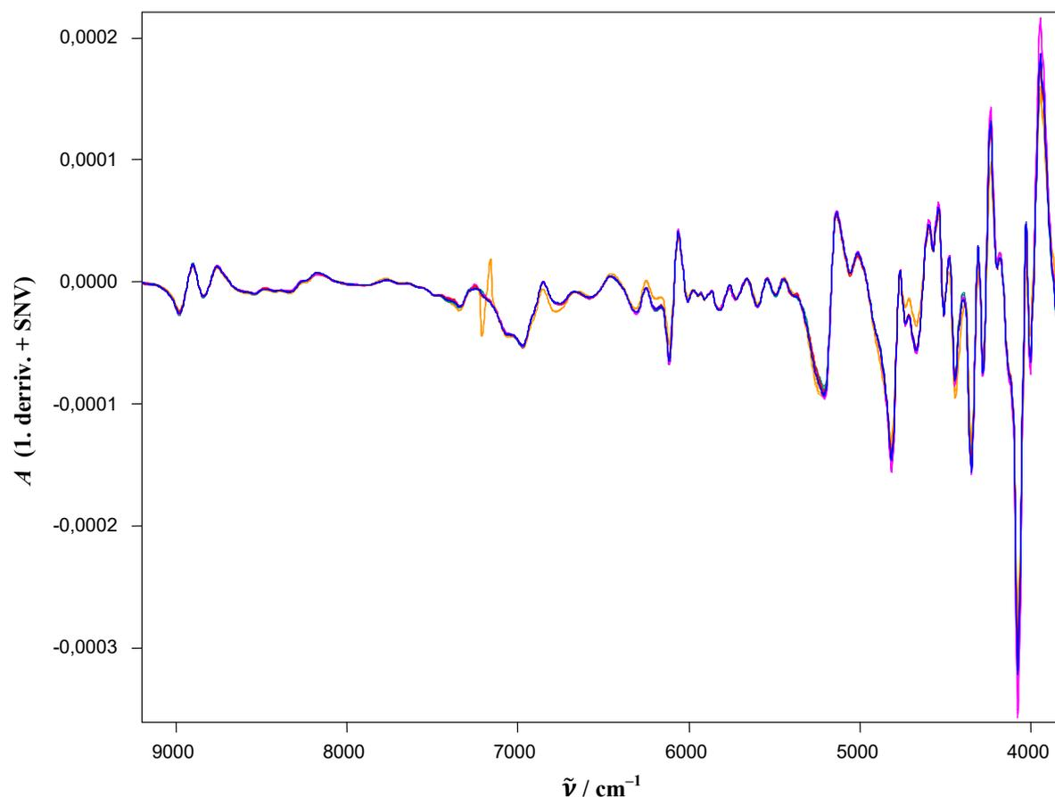
Slika 33. Matematički obrađeni (prva derivacija i normalizacija vektora) NIR spektri tableta alopurinola serije D1 (200 mg – plavo, promjera 9,5 mm), D3 (100 mg – crveno, promjera 7,0 mm), E1 (200 mg – rozo, promjera 9,5 mm), E3 (100 mg – zeleno, promjera 7,9 mm), D2S (100 mg – narančasto, promjera 8,06 mm) snimljeni difuznom refleksijom zračenja u području 12500–3800  $\text{cm}^{-1}$ .
