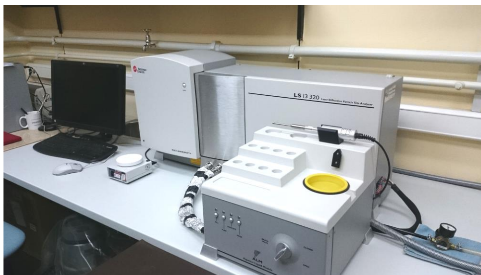
Slika 6. Laserski difrakcijski granulometar (Beckman Coulter LS 13 320); Institut Ruđer Bošković.
