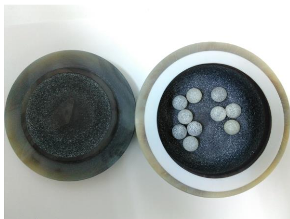
Slika 3.4. Ahatna posudica i kuglice za kuglični mlin Fritsch .
