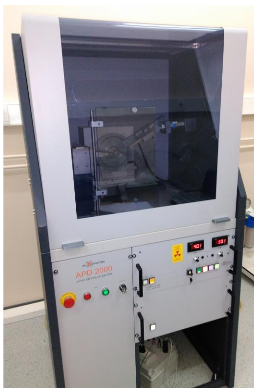
Slika 3.7. ItalStructures difraktometar APD 2000 za difrakciju na prahu.
