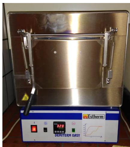
Slika 3.1. Peć za žarenje Estherm model Dermitem .
