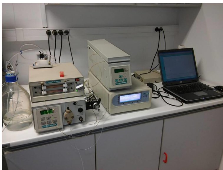
Slika 6. Ionski kromatograf tvrtke LabAlliance
