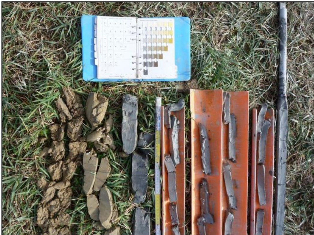
Slika 7. Primjer izvađene jezgre s terena s karticama Munsell-ovog dijagrama (Felja, 2017).
