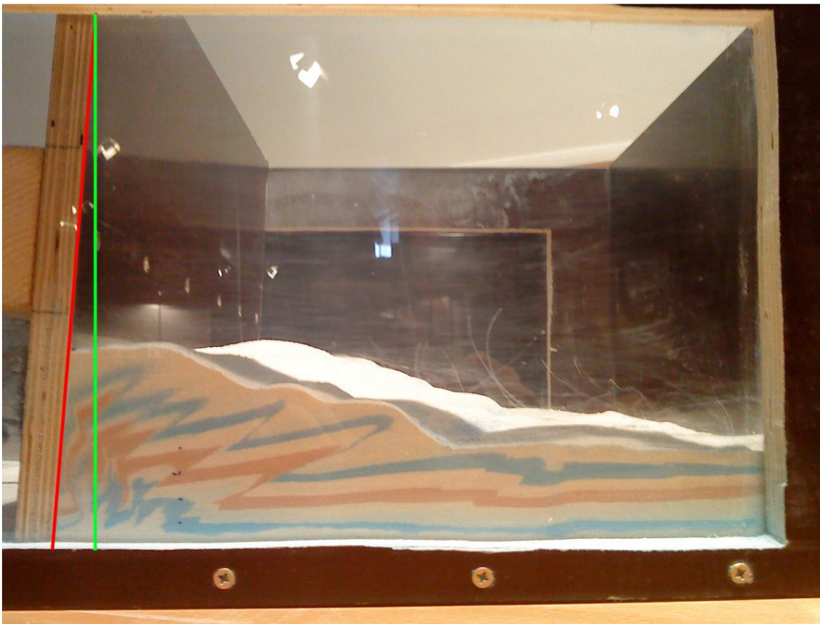
Slika 15: Jedan od pokusa iz 2015. Uočljivo je naginjanje pomičnog zida kao nedostatak izvornog dizajna aparature.
