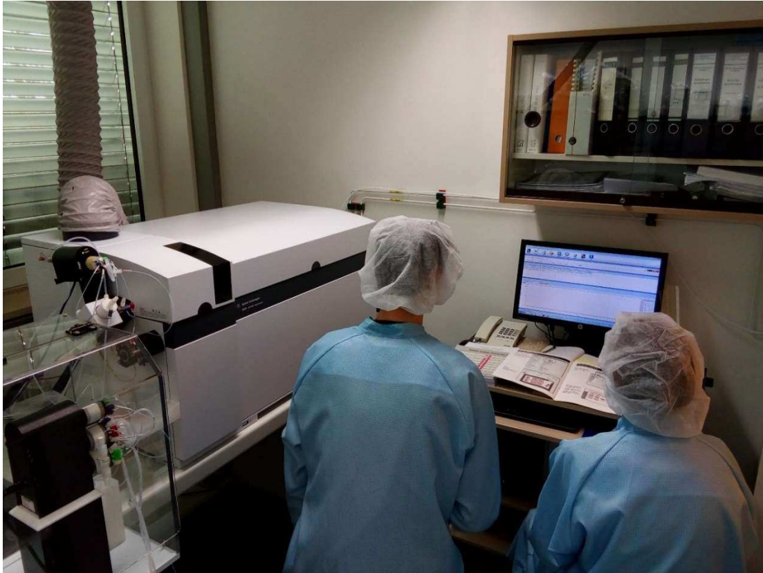
Slika 4.6.1. Analiziranje uzoraka na ICP-MS uređaju (institut Helmholtz-Zentrum Geestacht , Njemačka).
