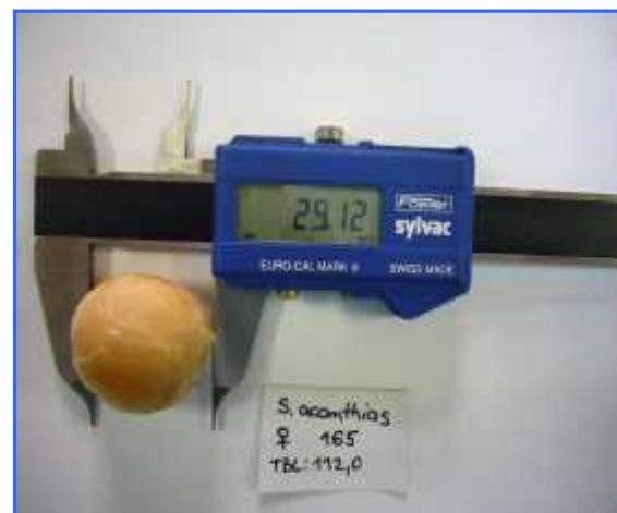
Slika 15. Mjerenje promjera jaja pomičnom mjerkom.
