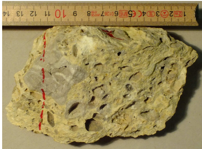
Slika 8) Uzorak litavca iz Bizeka. Šupljine nisu međusobno povezane.
