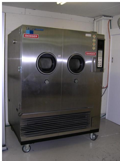
Slika 4. Ekološka komora koja ima mogućnost kontrole temperature i relativne vlažnosti (Preuzeto sa: www.emctech.com.au )
