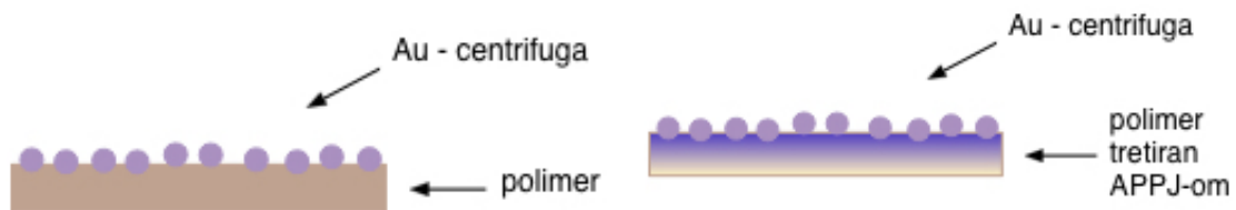
Slika 43. Shema impregnacije nanočestica na polimere za uzorke na Slici 44.
