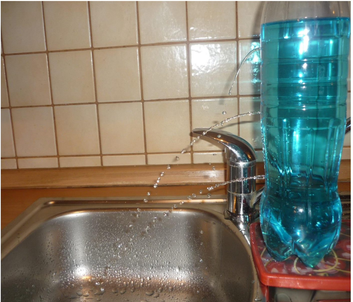
Slika 4.25. Ovisnost hidrostatskog tlaka o dubini
