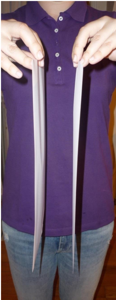
Slika 4.26. Listovi papira između kojih nema strujanja zraka
