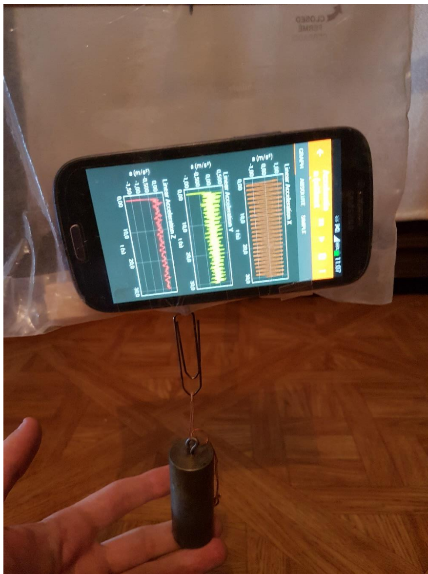
Slika 21: Ekran mobitela pokazuje slobodno titranje utega u intervalu od 30s.
