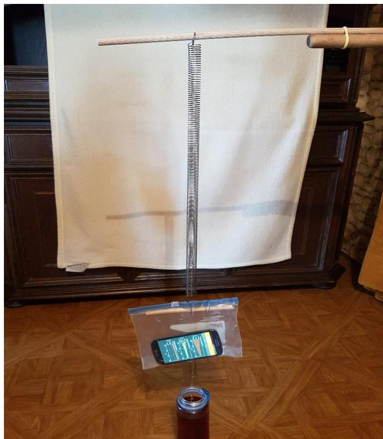
Slika 33: Eksperimentalni postav za prigušeno titranje u tekućini
