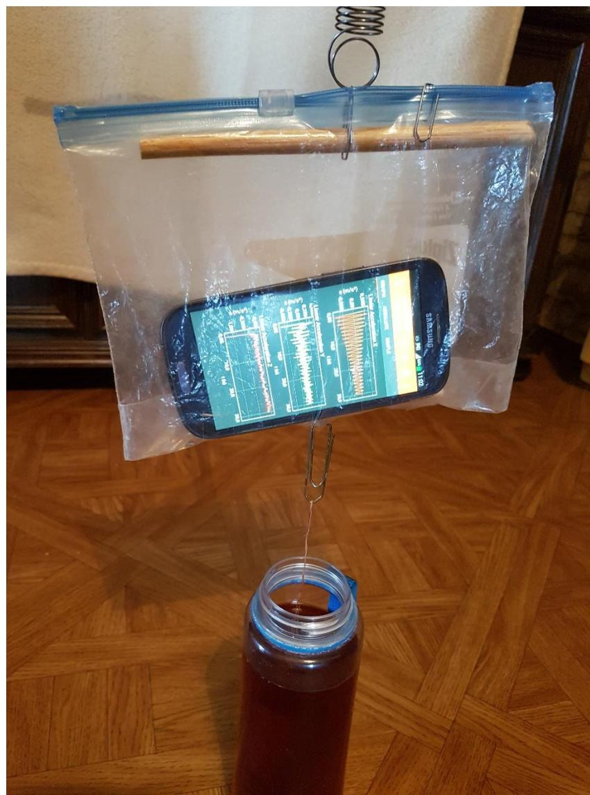
Slika 38: Prigušenje titranja u vinskom octu
