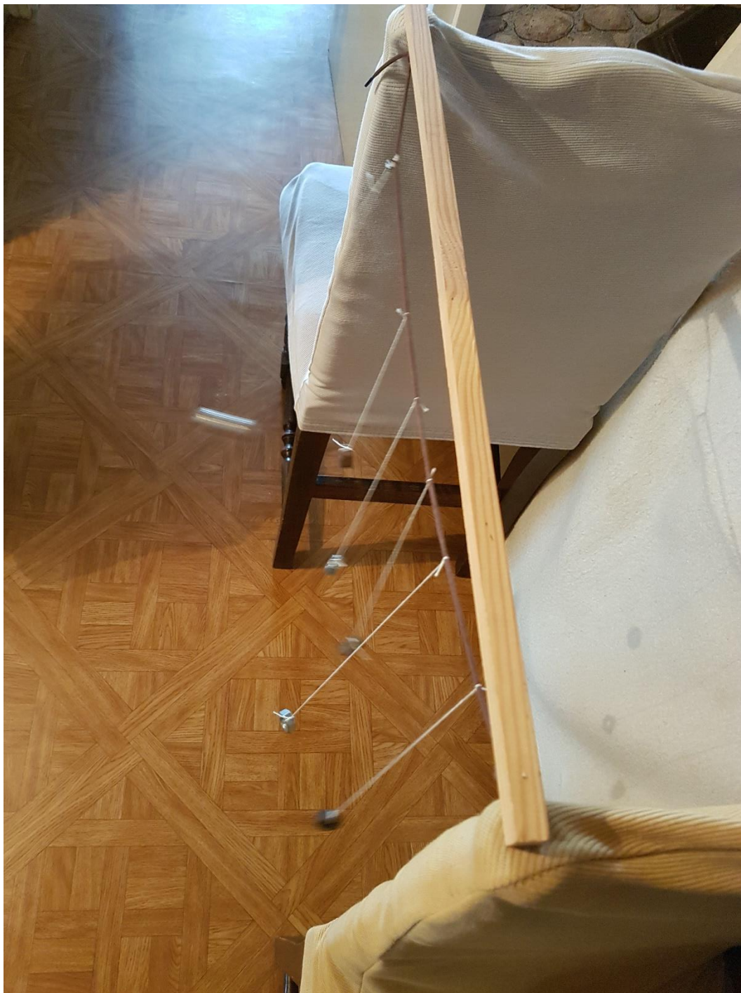
Slika 43: Njihala jednake duljine titraju najvećom amplitudom
