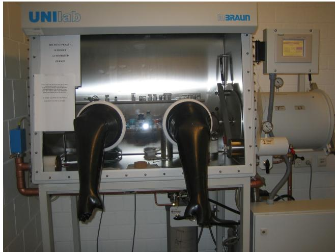
Slika 4.1: Glovebox poput onog korištenog u sintezi. Vidimo glavnu kutiju koja je pod atmosferom argona i gumene rukavice kojima se radi unutar gloveboxa. S desne strane je komora za unos koju se više puta ispumpa, napuni argonom i zatim ponovno ispumpa nakon što su se iz zraka unutra unijeli materijali za sintezu. Koncentracija vode i kisika je niska unutar gloveboxa tipično  $< 0.1 \text{ ppm}$ .
