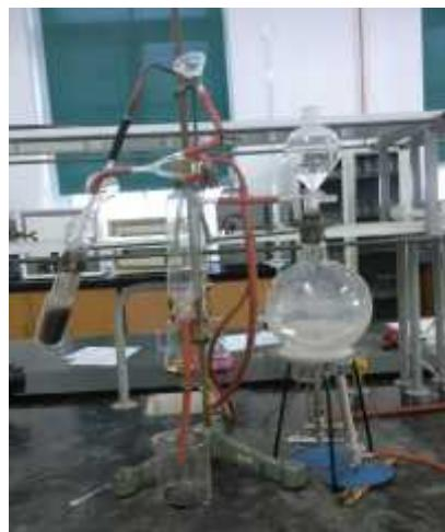
Slika 23. Aparatura za destilaciju
