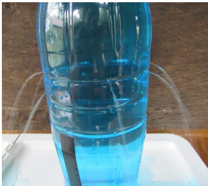
Slika 4.3. Plastična boca s rupicama na istoj visini.
