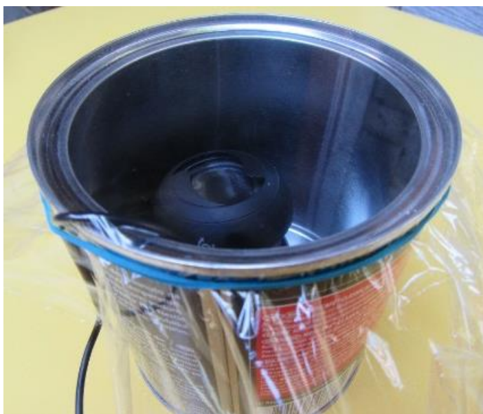
Slika 5.11. Posuda sa zvučnikom prekrivena prozirnom folijom učvršćena kuhinjskom gumicom.
