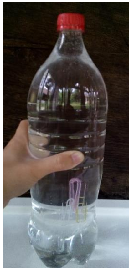
Slika 4.12. Pritiskom boce ronilac tone.
