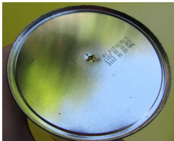
Slika 5.14. Probušena rupica na dnu limenke.
