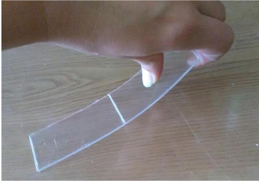
Slika 8. Prikaz elastičnosti pleksiglasa i način odvajanja ploha.
