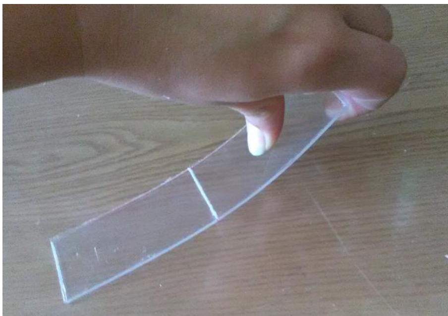
Slika 8. Prikaz elastičnosti pleksiglasa i način odvajanja ploha.
