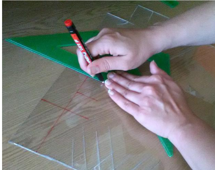
Slika 4. Zacrtavanje geometrijskih likova na pleksiglas.
