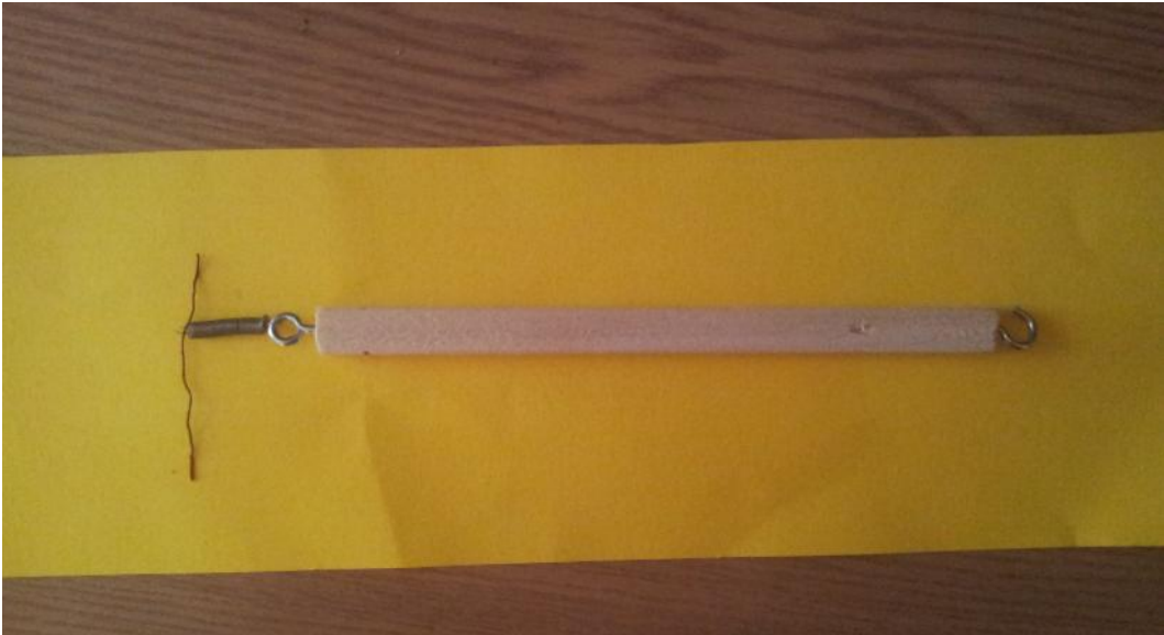
Slika 24. Dodavanje žice na oprugu.
