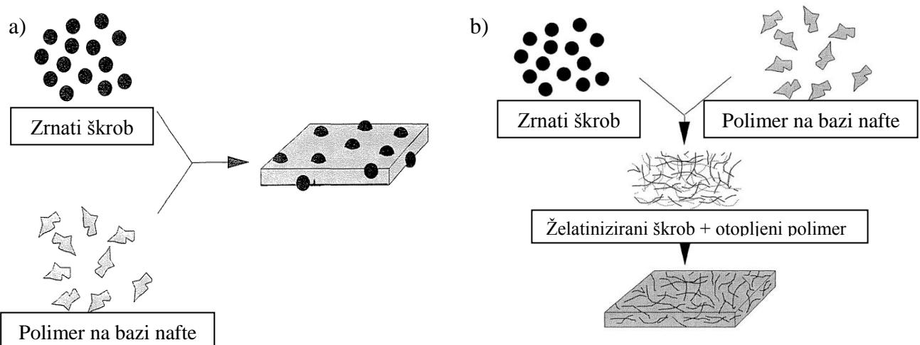
**Slika 2.** Proizvodnja mješavina plastike i škroba prema Griffinu (a) i Oteyu (b) (preuzeto iz Gould i sur. 1990.)
