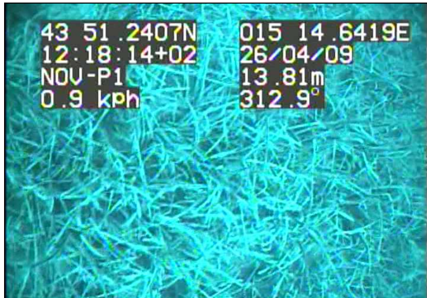
Slika 7. Primjer fotografije skinute s video-zapisa na kojoj se osim gustog naselja posidonije vide točni podaci o geo-poziciji, smjeru transekta, vremenu, datumu, brzini plovila te dubini ispod njega
