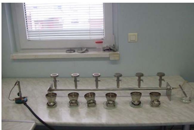
Slika 7. Uređaj za membransku filtraciju (Vlastita fotografija)
