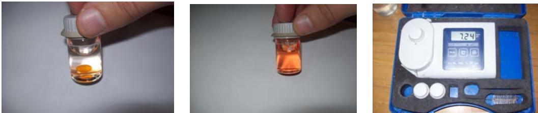
Slika 17. Mjerenje pH vrijednosti aparatom Dulco Test DT1 (Vlastite fotografije)
