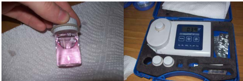
Slika 18. Mjerenje slobodnog rezidualnog klora aparatom Dulco Test DT1 (Vlastita fotografija)
