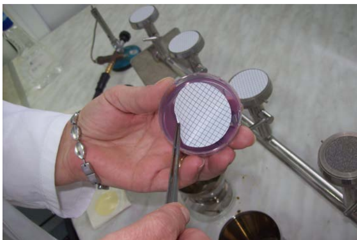
Slika 12. Stavljanje filtra na m-FCA agar (Vlastita fotografija)
