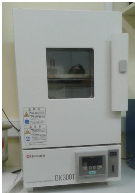
(a) Peć za predgrijavanje Yamato DK300T.
