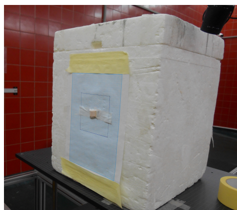
(b) Dozimetri za provjeru kalibracije naljepljeni na stiropor.
