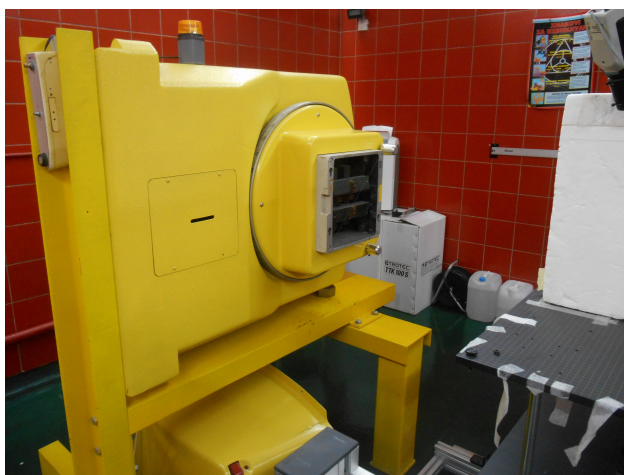
(a) Kućište sa izvorom ^{60}\text{Co} .
