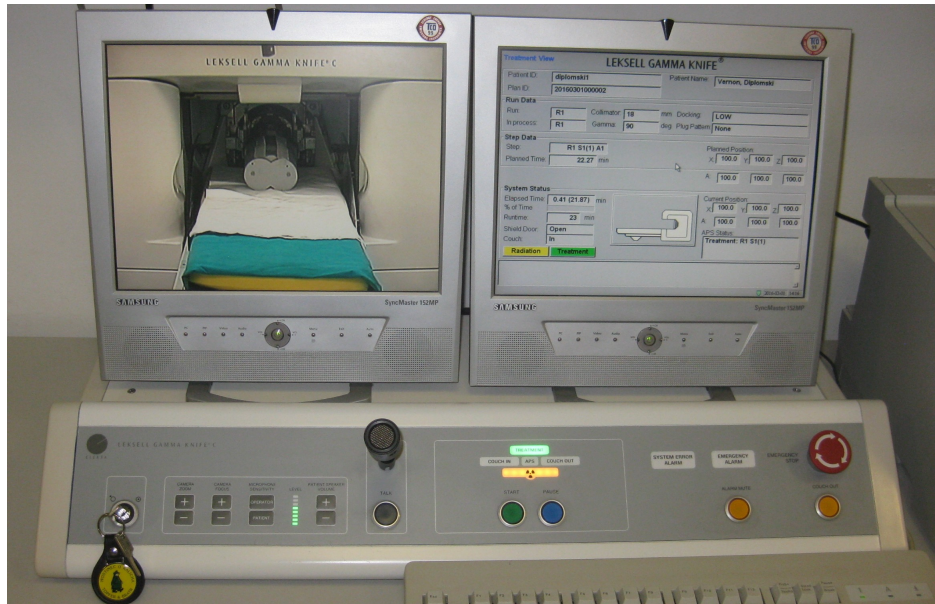
Slika 3.4: Kontrolna jedinica i fantom sniman kontrolnom kamerom za vrijeme zračenja.
