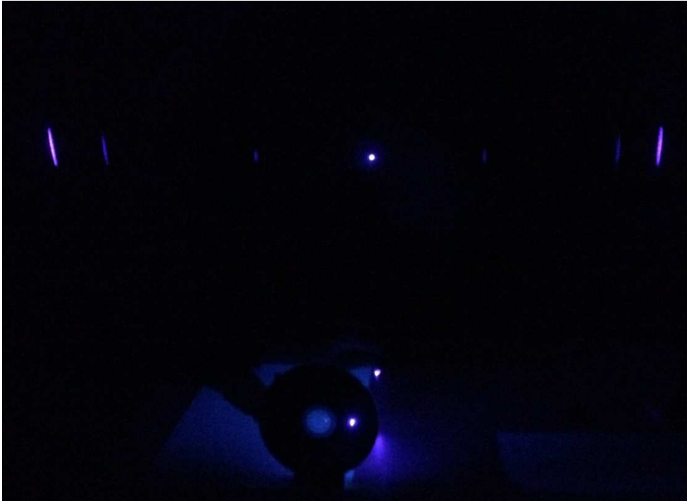
Slika 4.4.4 Difrakcija plave svjetlosti na CD-u
