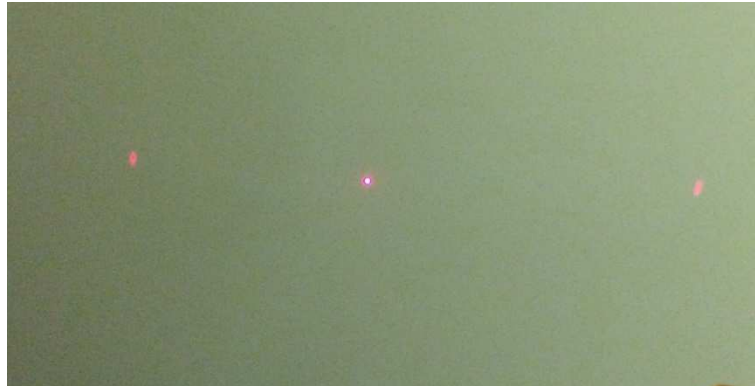
Slika 4.4.2 Difrakcija crvene svjetlosti na CD-u
