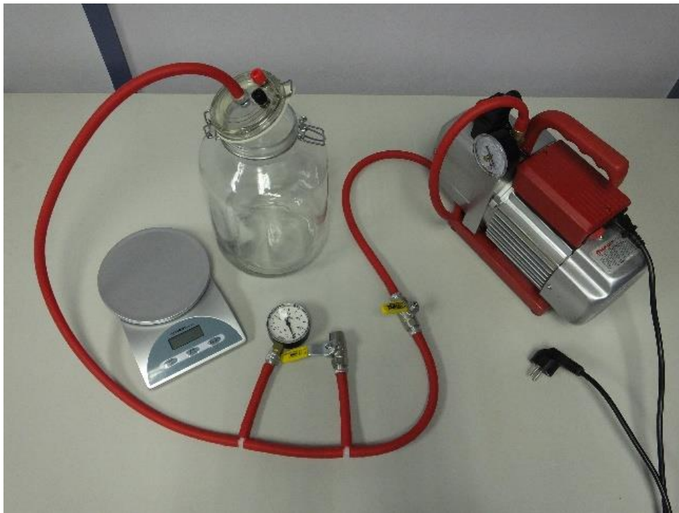
Slika 4.6.1. Eksperimentalni postav za vježbu vaganje zraka
