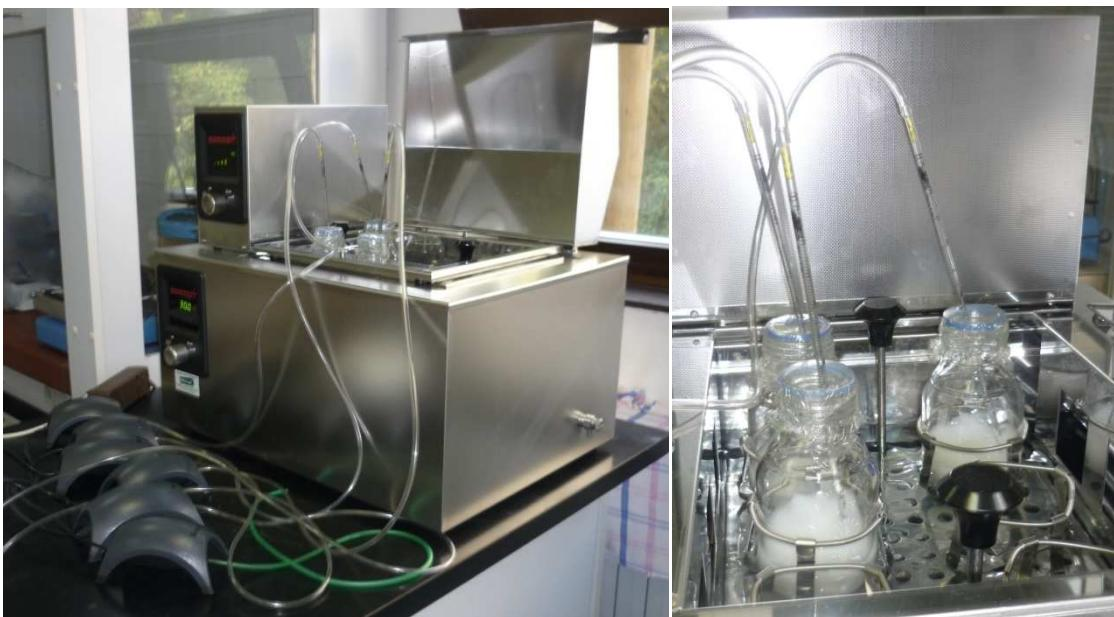
**Slika 9.** Vodena kupelj s tikvicama i sustavom za prozračivanje
