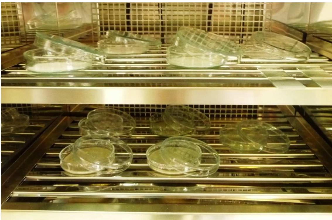
**Slika 11.** Uzorci materijala u suhom sterilizatoru
