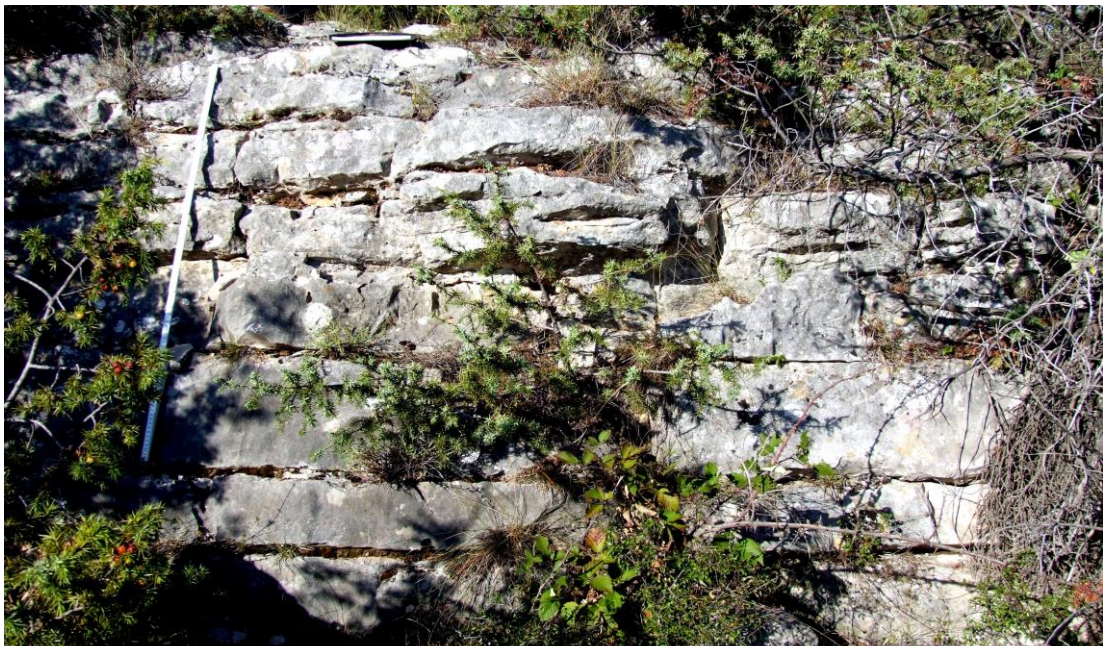
Sl. 9 Slojevi karbonatnih pješčenjaka "naslagani jedan na drugi" (amalgamirani) s jedva primjetnim lateralnim isklinjavanjem ukazuju na taloženje u vrlo širokim kanalima. Mjestimice su između slojeva sačuvani, tanki, slojevi kalklutita debljine od 1 do 2 cm. Mjerilo je dužine 1 m. Snimljeno u jarku Drage Čavrića.
