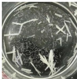
Slika 14. Kristali spoja [\text{CdI}_2(4\text{-Hoxpy})_2]_n .
