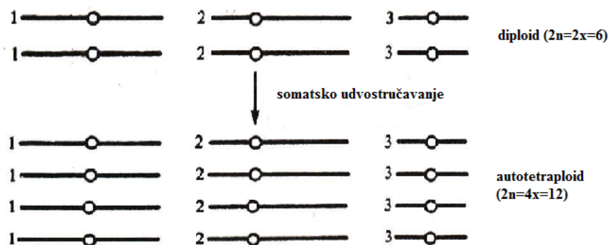
Slika 3. Shematski prikaz mehanizma nastanka autopoliploida zbog procesa somatskog udvostručavanja kromosoma (pogreška u mitozu).
