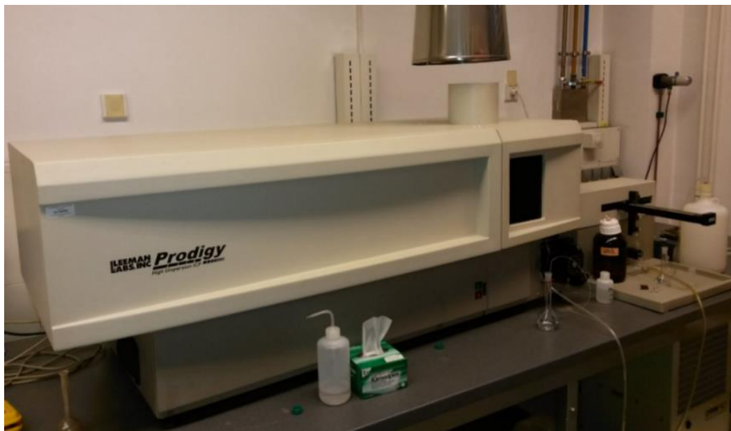
Slika 10. Optički emisijski spektrometar Prodigy High Dispersion ICP (Teledyne Leeman Labs., Hudson, NH, USA)
