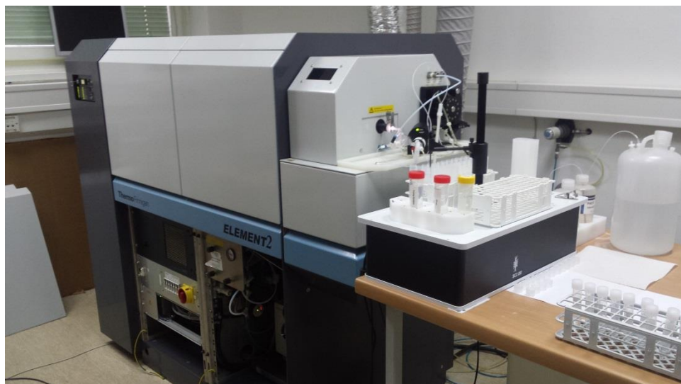
Slika 9 Maseni spektrometar visokog razlučivanja s induktivno spregnutom plazmom (HR ICP-MS, Element 2, Thermo Finnigan, Bremen, Njemačka) i Autosampler ASX 510
