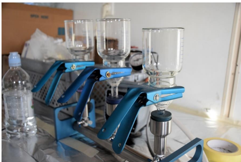
Slika 8. Aparatura za filtraciju
