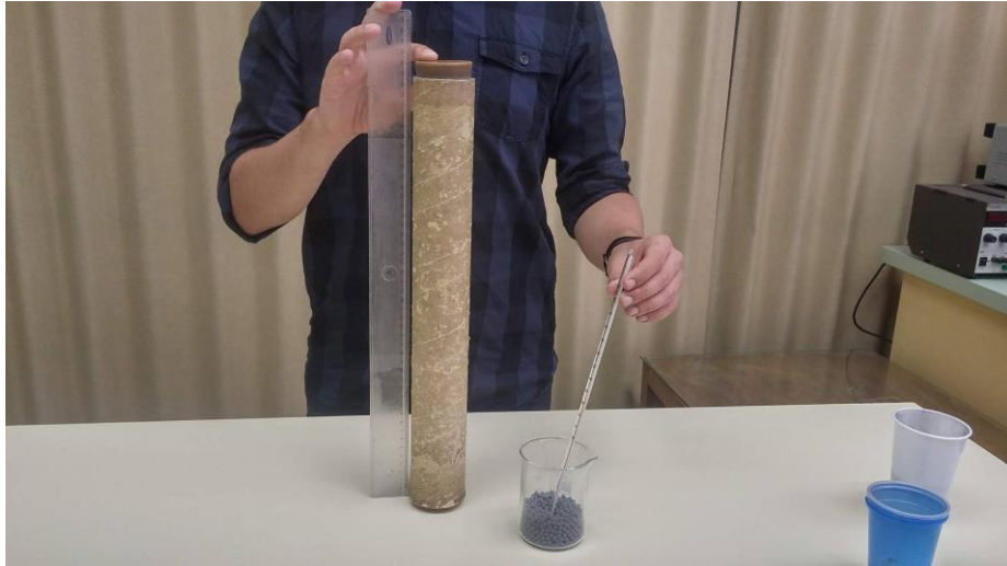
Slika 19. Mjerenje visine kartonske cijevi te temperature sačme prije izvođenja pokusa
